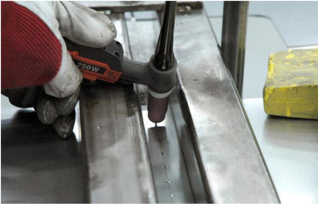
Kuva 22. MicroTackilla silloitettu liitos.
