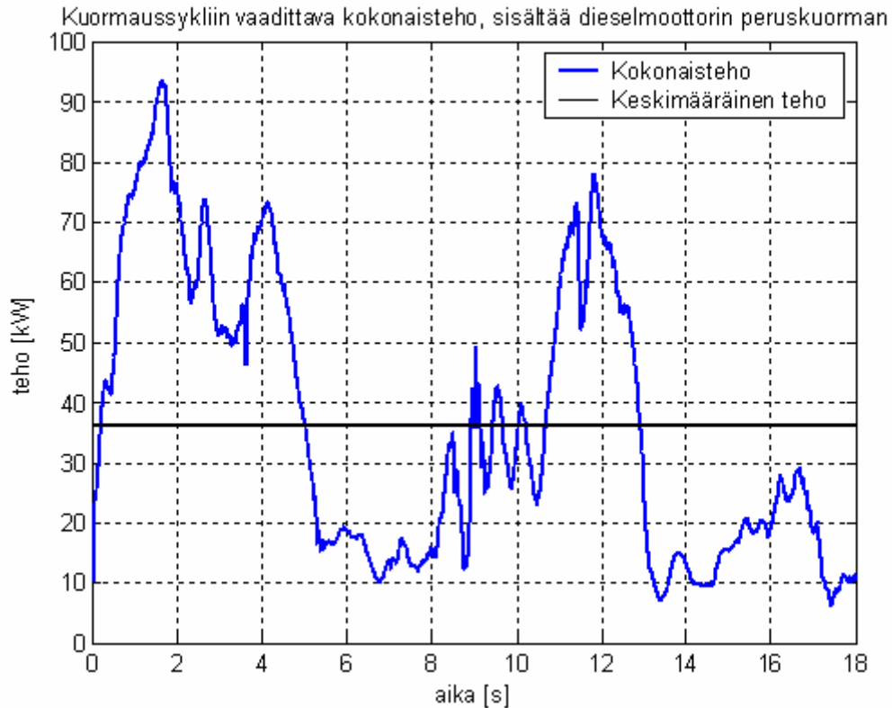
Kuva 44. Kuormaussykliin jakovaihteettomassa järjestelmässä vaadittava kokonaisteho, kun talteen saatava teho ja dieselmoottorin peruskuorma on otettu huomioon.
