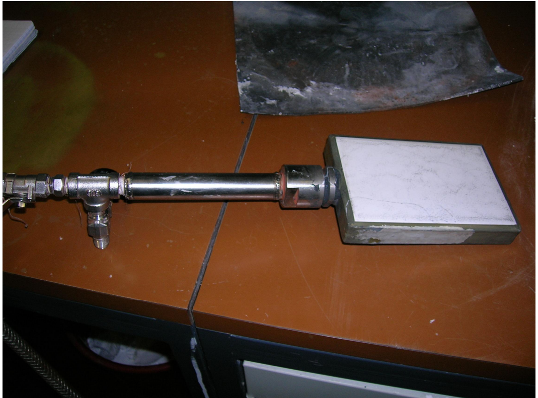
Kuva 16. Työssä käytetty keraaminen laatta pidikkeeseensä kiinnitettynä
