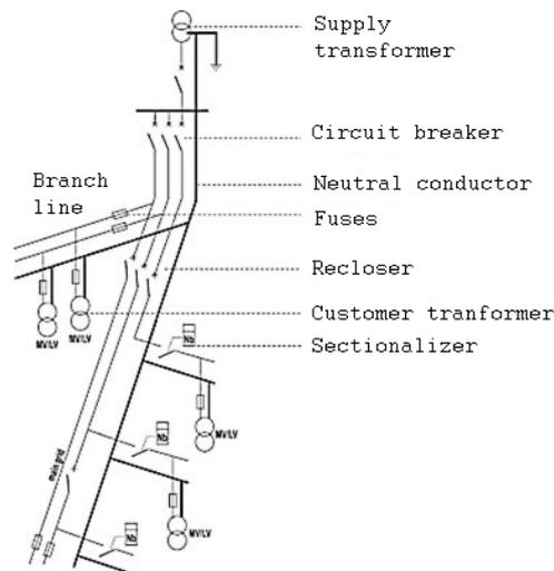
Figure 8. 13.8 kV network in the USA (Titenkov)
