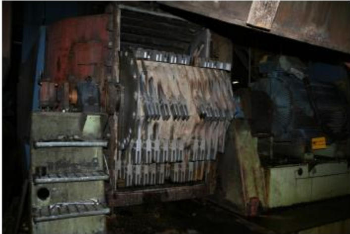
Kuva 13 Vasaramylly (Wadsborn et al. 2007, 10)
