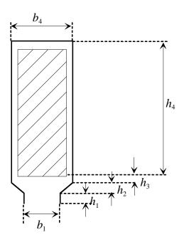
Fig. 2.11. Slot dimensions.
