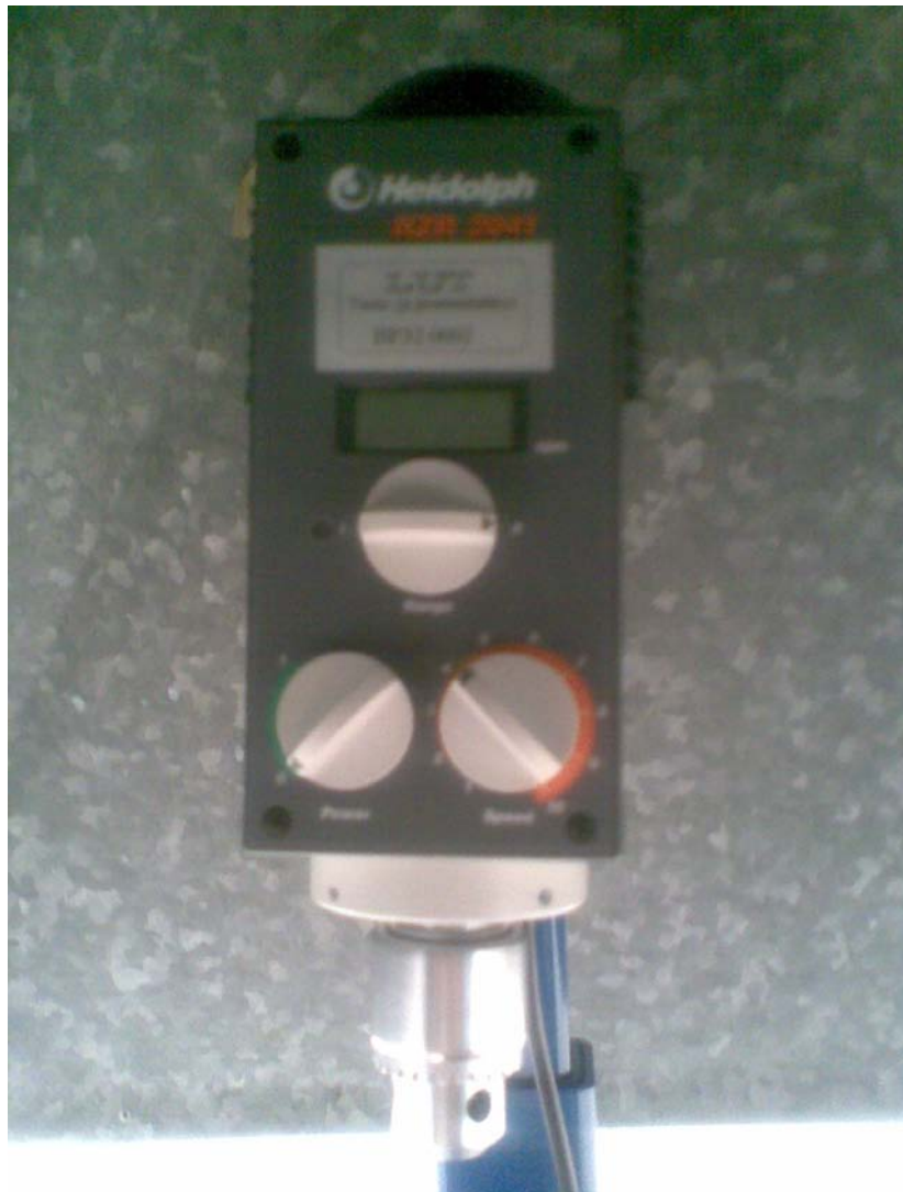
Kuva 5. Sekoittimessa on kierrosnopeuden portaaton säätö ja digitaalinen näyttö.
