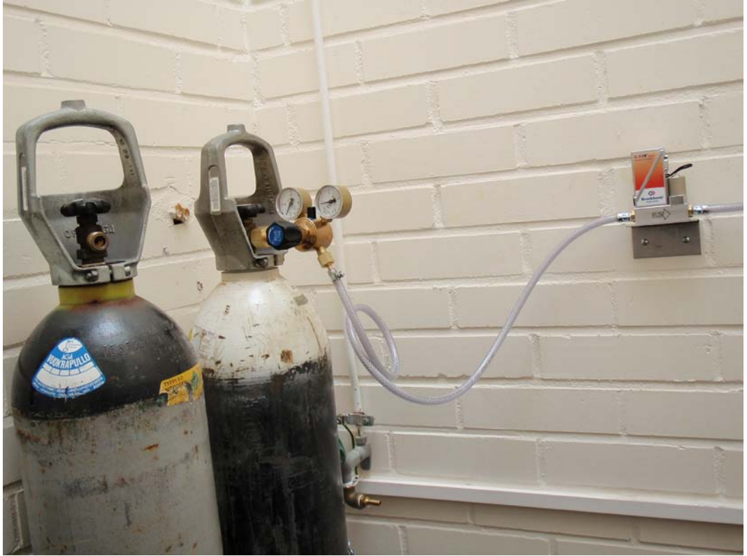
Kuva 7. Kuvassa oikealla virtauksensäätölaitteisto, johon molemmat kaasupullot kytketään.
