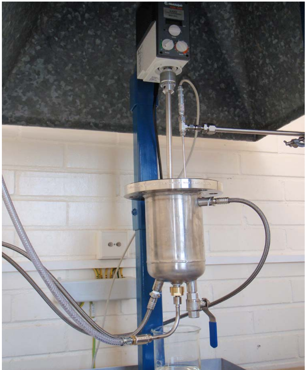
Kuva 3. Reaktori ilman kantta. Ylhäällä sekoitin ja lämpötila-anturi. Sivussa ja pohjassa on lämmitysnestekierto. Pohjassa on myös näytteenottoventtiili ja kaasulinja.
