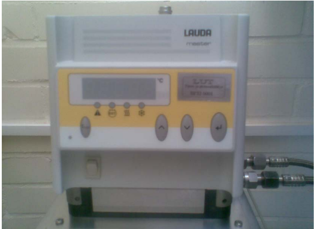
Kuva 6. Termostaatti, jossa on digitaalinen näyttö lämpötilalle ja automaatio, jolla pystytään pitämään reaktorin lämpötila haluttuna.
