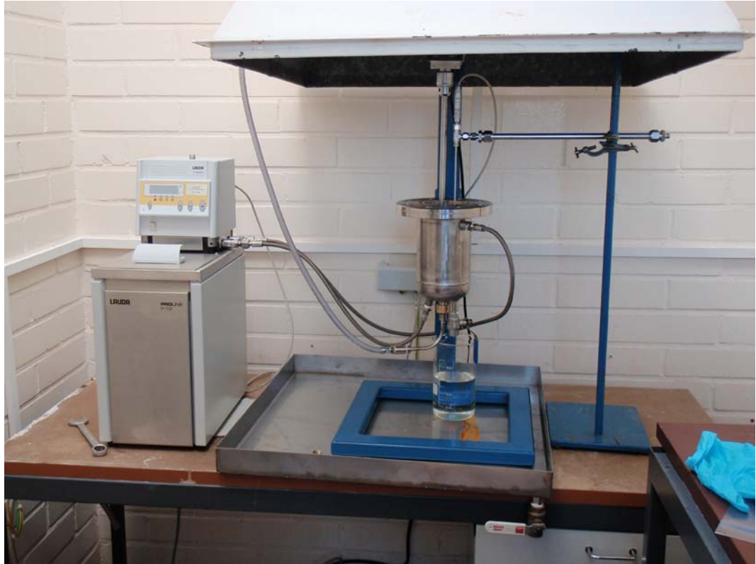
Kuva 4. Vasemmalla on termostaatti säätölaitteineen ja hätä-allas reaktorin alla. Kuvasta puuttuu reaktorin eteen asennettava roiskesuoja.
