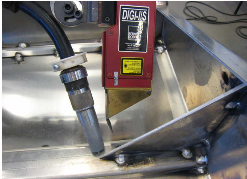
Kuva 20. Esimerkkitapaus optisen anturin tuomasta rajoitteesta ahtaassa hitsauskohteessa.
