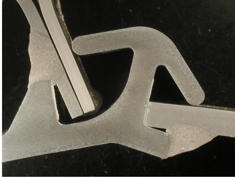
Kuva 19. Makrohie alumiiniprofiilin koehitsistä.
