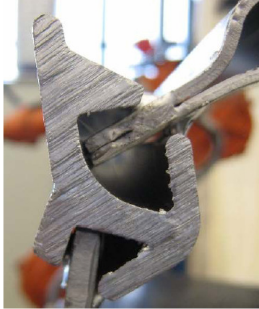
Kuva 13. Alumiiniveneessä käytettävä profiili ja siihen silloitetut ohutlevyt.
