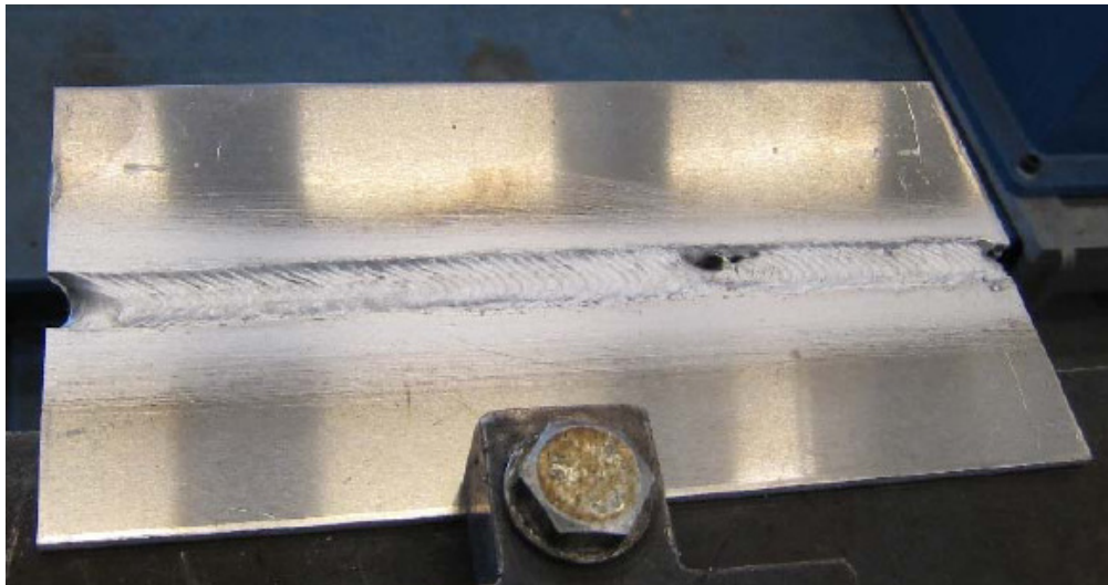
Kuva 17. Alumiinin päällekkäisliitoksen hitsaus optista railonseurantaa hyödyntäen.
