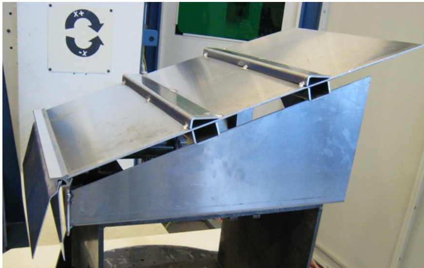
Kuva 16. Ulottuvuustarkastelussa käytetty, alumiiniveneen pohjaa mallintava koekappale.
