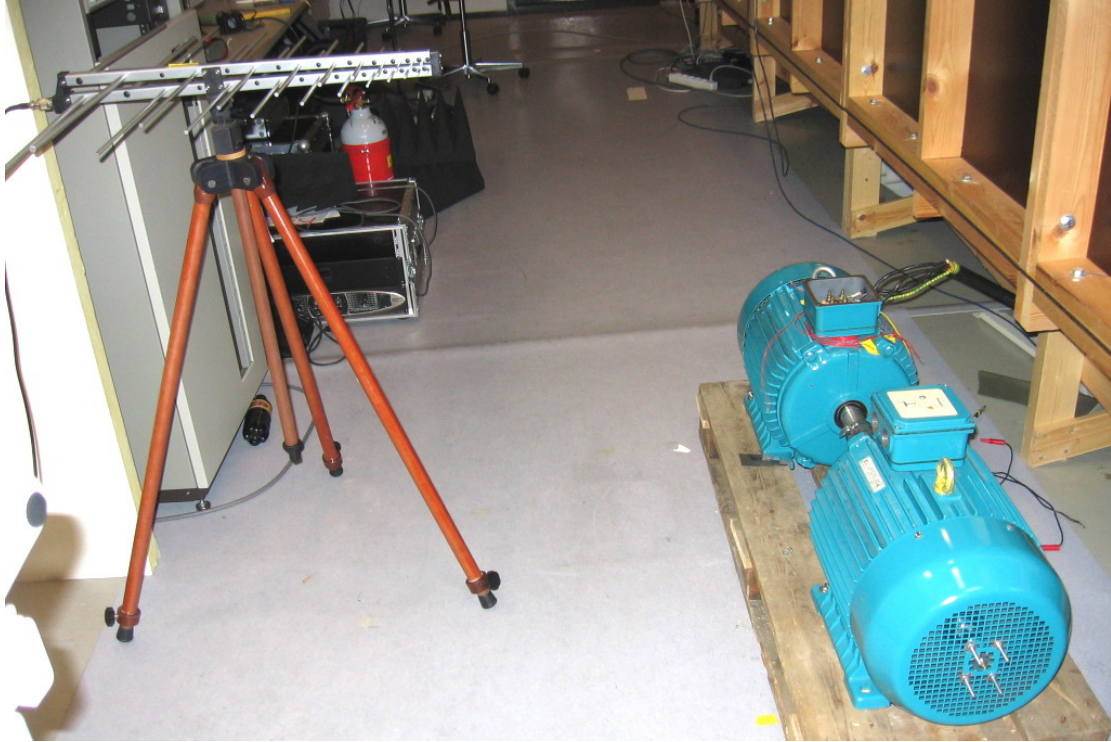
Kuva 4.2. Mittauksessa käytetty antenni sekä sähkömoottori.
