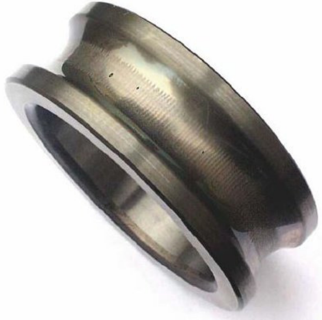
Kuva 2.3. Pitkittäisiä uria laakerin sisäuralla (SKF 2008).
