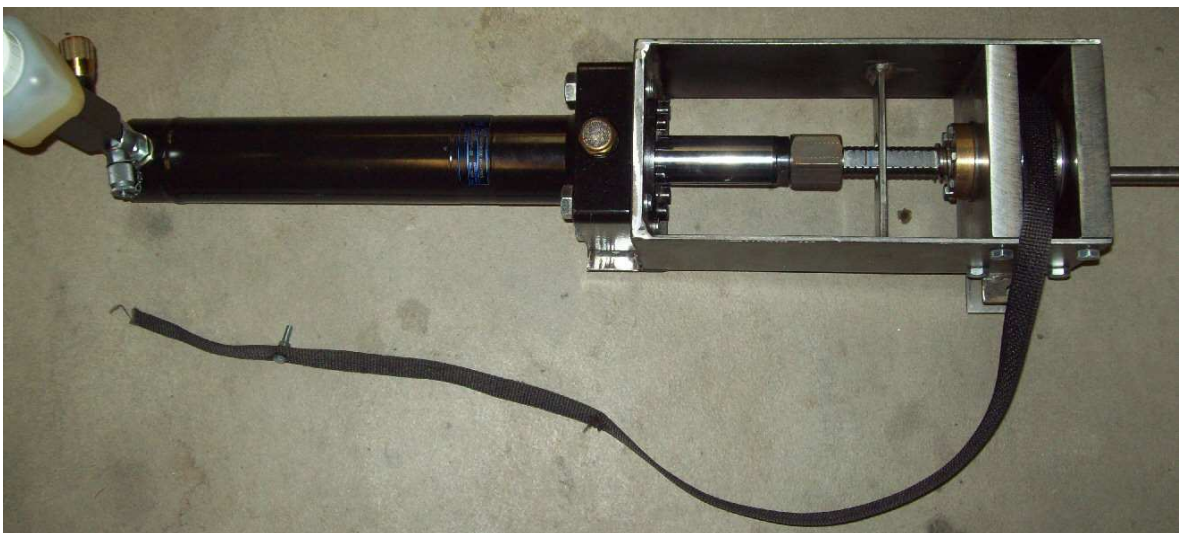
Kuva 16. Voimamittauslaitteen prototyypin lopullinen kokoonpano. (Emering 2009.)
