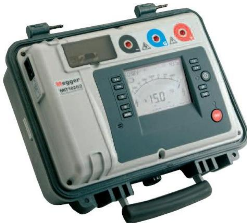
Kuva 4.1 Megger MIT1020 mittalaite. (Meg 2010)
