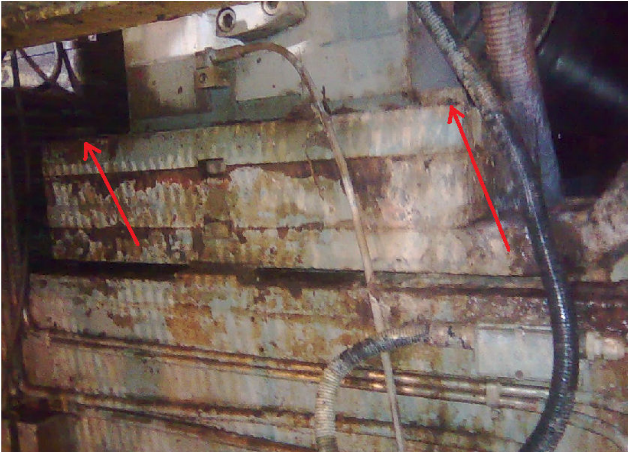
Kuva 9. Telan laakeripesä. Kiinnitysruuvit osoitettu nuolilla.
