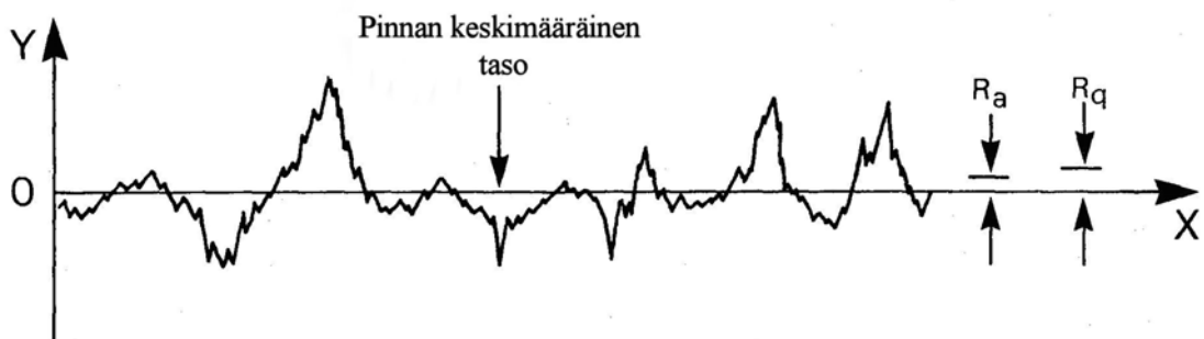
Kuva 1. Suoran kappaleen pinnankarheus profiili. Kuvaan merkitty keskimääräinen - ja rms-karheus. /2/
