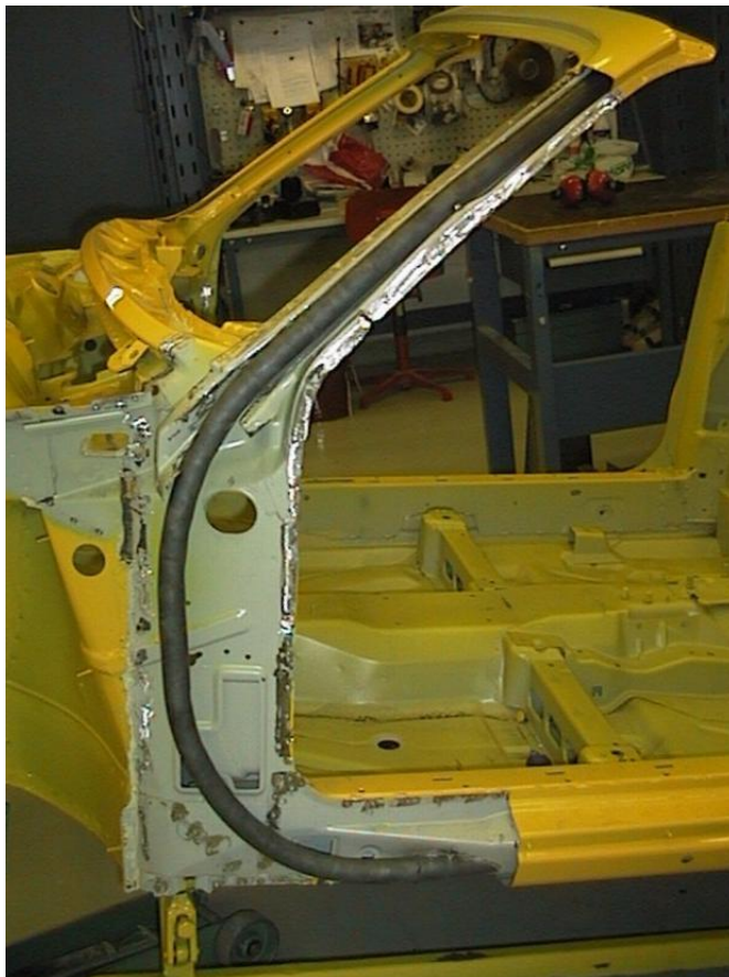
Kuva 5.1.2.1. Auton vasemman sivun A-pilarin vahvikeputki lopullisessa muodossaan.
