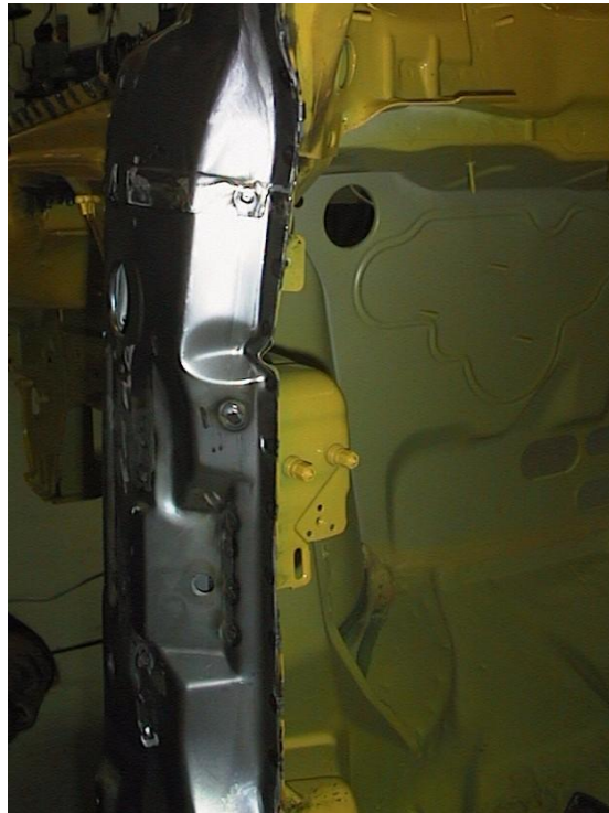
Kuva 5.3.6. Syvä paikallinen lommahdus A-pilarin vertikaaliosan takapinnalla
