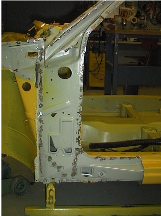
Kuva 5.1.1.2. Lähikuva puretusta A-pilarin vertikaaliosasta ja kynnyspalkista.
