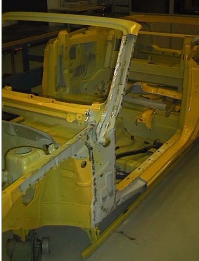
Kuva 5.1.1.1. Tarvittavat peltiosat irrotettuna vahvikeputken asentamista varten.
