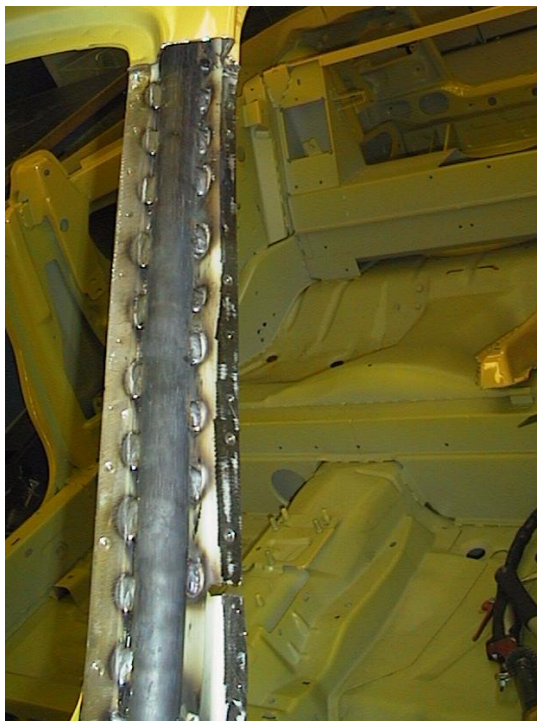
Kuva 5.1.3.1. Vahvikeputken liitoshitsit A-pilarin viisto-osan alueella.
