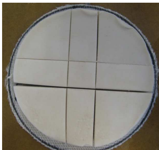
Kuva 18. Kakun paloittelu johtokyky- ja kosteuspitoisuusmittauksia varten.
