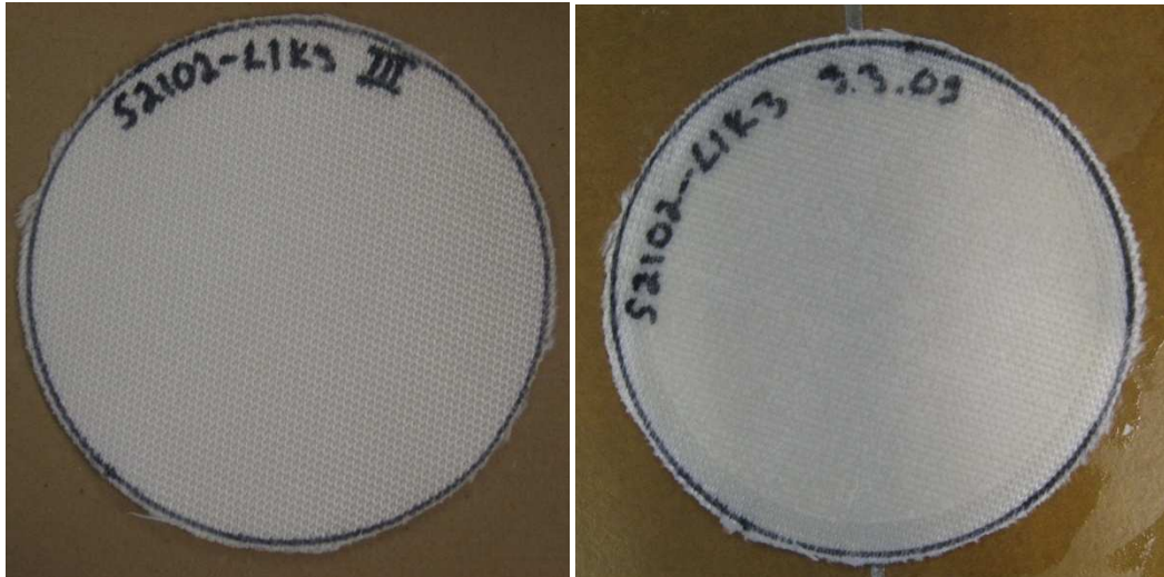
Kuva 21. Tamfeltin S2102-L1K3 suodinkankaita. Vasemmalla käyttämätön ja oikealla suodatuksen jälkeinen kangas.
