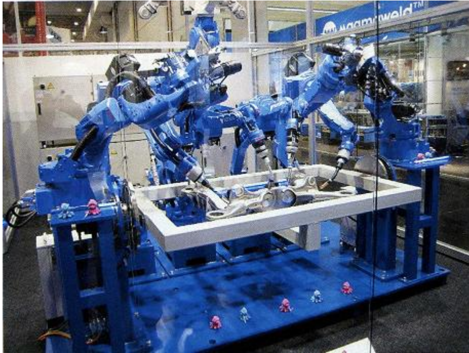
Kuva 4. Seitsemän robotin monirobottiasema, jossa kaapelointi on integroitu robottien käsivarsiin (Hiltunen 2009, s. 30).
