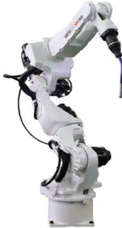
Kuva 3. Erityisesti monirobottiasemiin soveltuva 7-akselinen nivelvarsirobotti VA1400 (Motoman VA1400).
