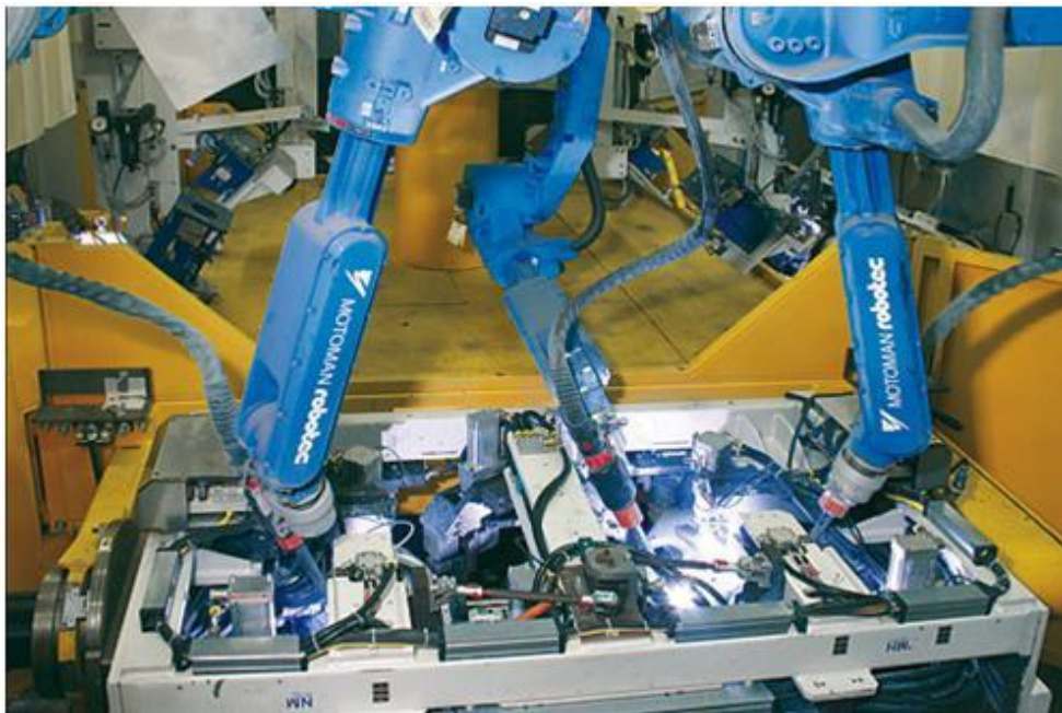
Kuva 15. Dingolfingin tehtaalla toimiva kolmen hitsaavan robotin monirobottiasema (Etuakseleiden hitsaus, s. 1).
