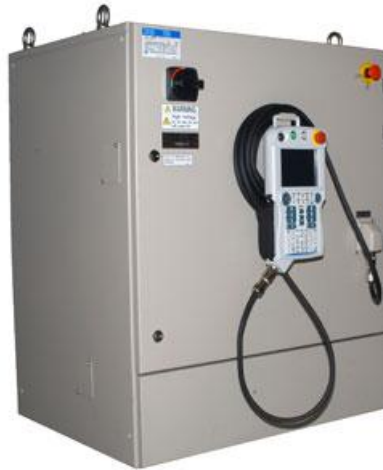
Kuva 10. Motomanin DX100 robottiohjain, jolla voidaan ohjata yhteensä 72 akselia (DX100 2009).
