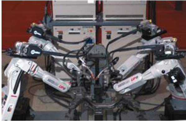
Kuva 9. Neljä hitsaavaa robottia, jotka toimivat synkronoidusti yhdellä monirobottiohjaimella (Morel 2003).
