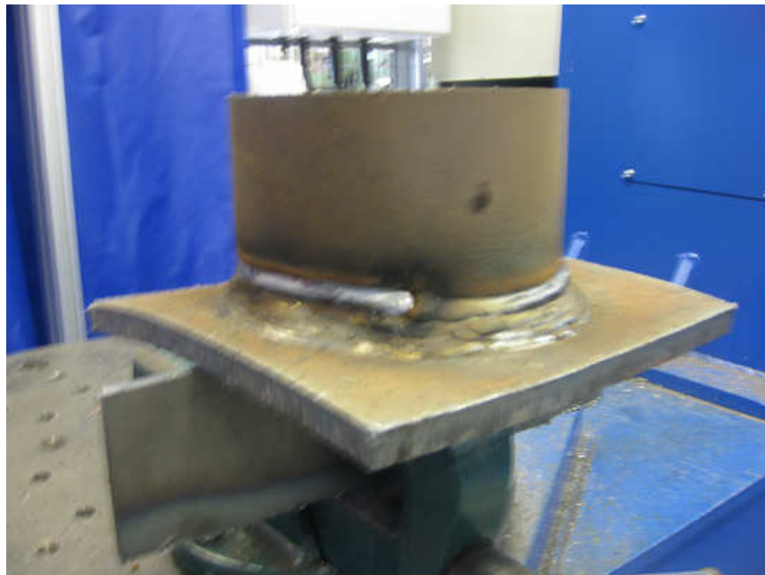
Kuva 16. Kappale kaikki palkokerrokset hitsattuna.
