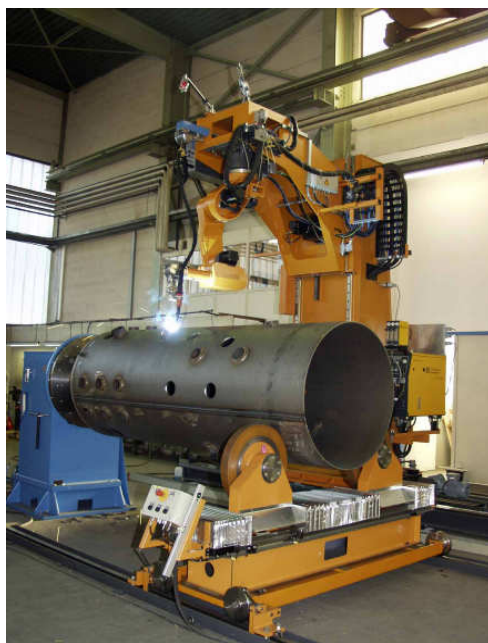
Kuva 23. Robotisioitua säiliön yhteiden hitsausta (cloos 2003).
