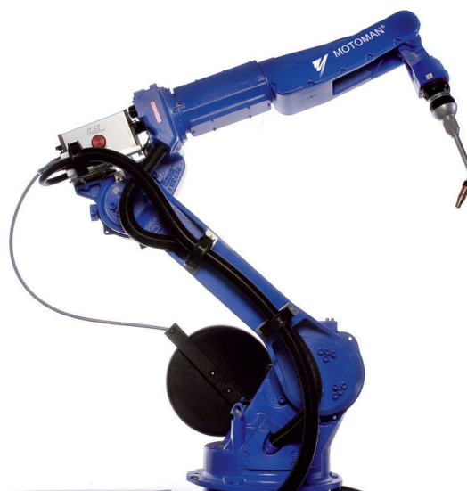
Kuva 2. Motomanin EA 1900 N kaarihitsaukseen tarkoitettu robotti (Motoman 2010).
