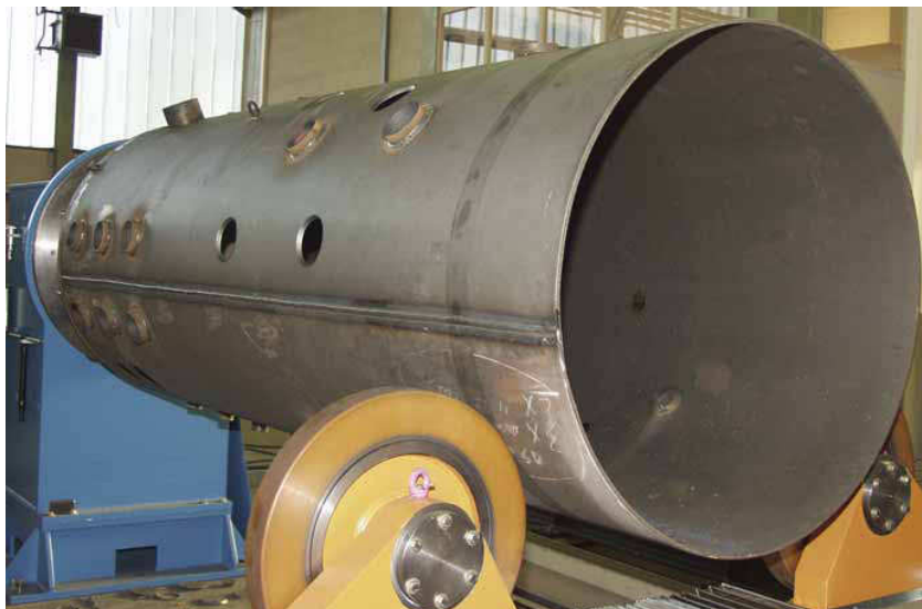
Kuva 10. Säiliön käsittelylaitteisto. Toinen pää makaa rullien päällä ja toinen pää kiinnitetty laitteeseen, joka pyörittää säiliötä. (Cloos 2003.)
