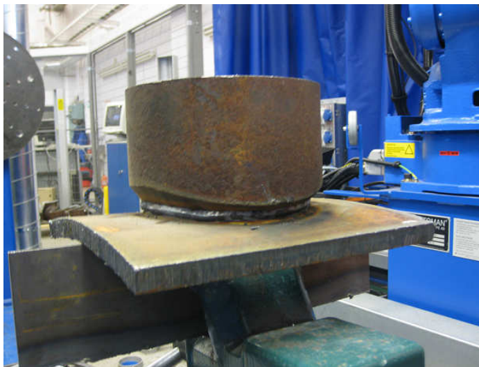
Kuva 14. Kokkappale asetettiin putken suuaukko kohtisuoraan ylöspäin.
