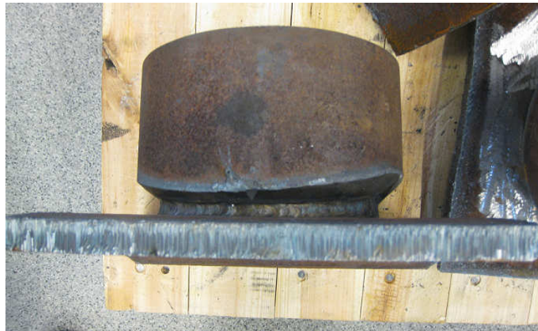
Kuva 18. Koekappale, jolle hitsauskoe suoritettiin. Pohjapalko on hitsattu valmiiksi käsivaraisesti TIG-hitsausprosessilla.
