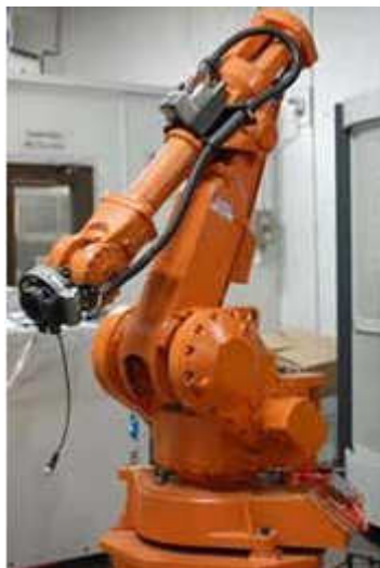
Kuva 3. ABB:n 4400/60 robotti jota käytetään plasmaleikkaukseen (abb 2010).
