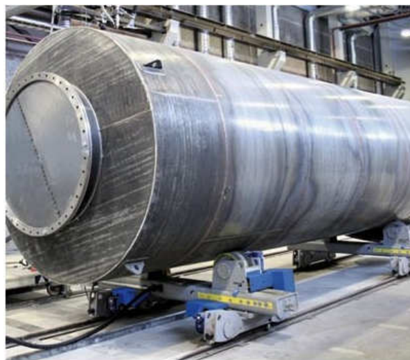
Kuva 9. Säiliöiden käsittelylaitteena voi olla rullastot, jolloin säiliön saa käännettyä hitsausta varten edullisimpaan asentoon. (Pemamek 2010)
