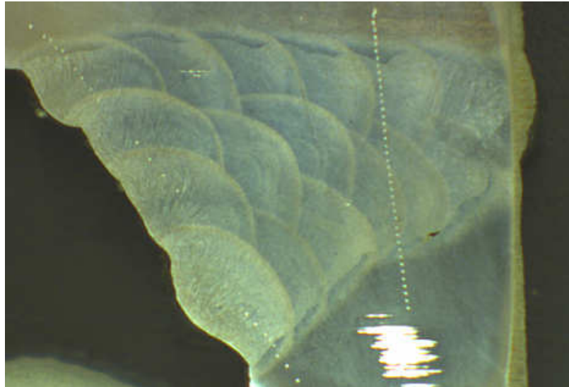
Kuva 17. Makrohie koehitsatusta kappaleesta. Yksi liitosvirhe on havaittavissa kuvan oikeassa alareunassa muutosvyöhykkeen reunalla. Muita virheitä hieessä ei ole näkyvissä.
