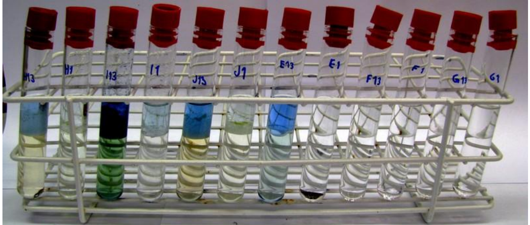
Kuva 20. Alkulämpötila 40 °C, näytteet vasemmalta oikealle pareittain, t = 120 min ja t = 5 min: 1–2, pilkotut lehdet ja suola; 3–4, pilkotut lehdet ja happo; 5–6, pilkotut lehdet ja puhdas vesi; 7–8, kokonaiset lehdet ja happo; 9–10, kokonaiset lehdet ja suola; 11–12, kokonaiset lehdet ja puhdas vesi.
