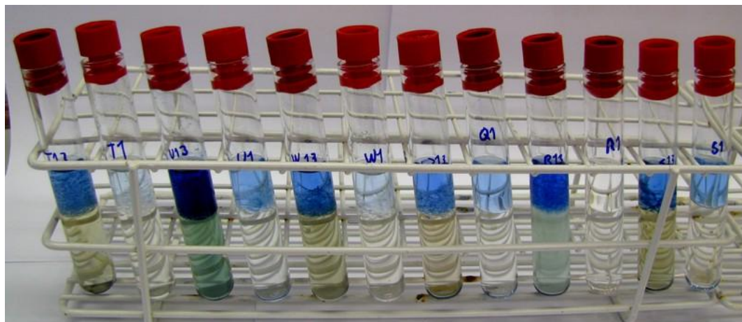
Kuva 22. Alkulämpötila 80 °C, näytteet vasemmalta oikealle pareittain, t = 120 min ja t = 5 min: 1–2, pilkotut lehdet ja suola; 3–4, pilkotut lehdet ja happo; 5–6, pilkotut lehdet ja puhdas vesi; 7–8, kokonaiset lehdet ja suola; 9–10, kokonaiset lehdet ja happo; 11–12, kokonaiset lehdet ja puhdas vesi.
