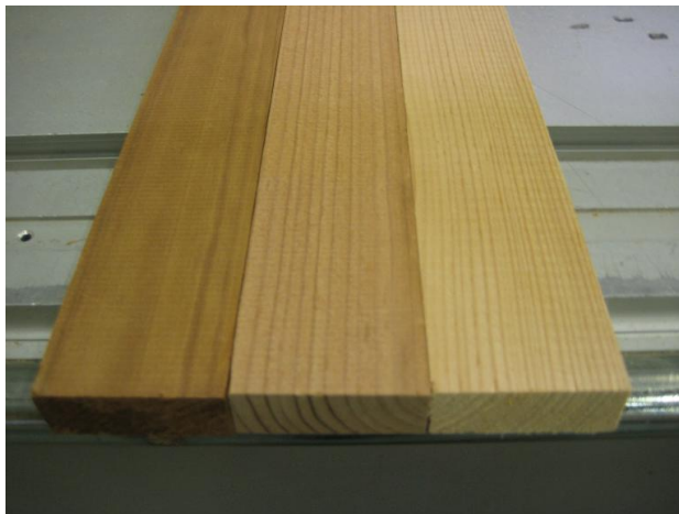
Kuva 12. Eri lämpötiloissa käsiteltyjen mäntykappaleiden tummuusaste poikkeaa selvästi toisistaan.
