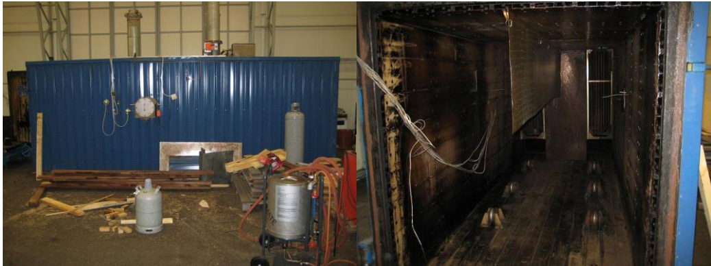
Kuva 2. Lämpökäsittelykammio Ruokolahdella (ulkoa ja sisältä).
