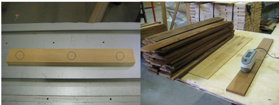
Kuva 4. Periaatekuva värin mittauskohtien valinnasta (vas.) ja spektrofotometri, joka asetettiin puukappaleiden päälle kuvan mukaisella tavalla (oik.).
