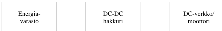
Kuva 1.1. Energiavaraston kytkeminen DC -verkkoon tai DC -moottoriin.
