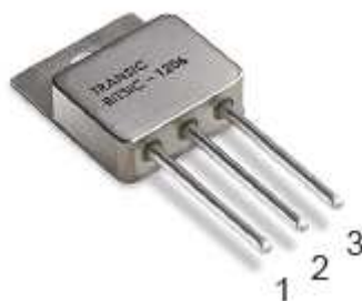
Kuva 3.8 TranSiC:in BitSiC BT1206AB-P1 -transistorin kotelo (TO-258), jossa luku 1 merkitsee transistorin kanta-, luku 2 emitteri- ja luku 3 kollektoripinniä. (Lindgren 2010)
