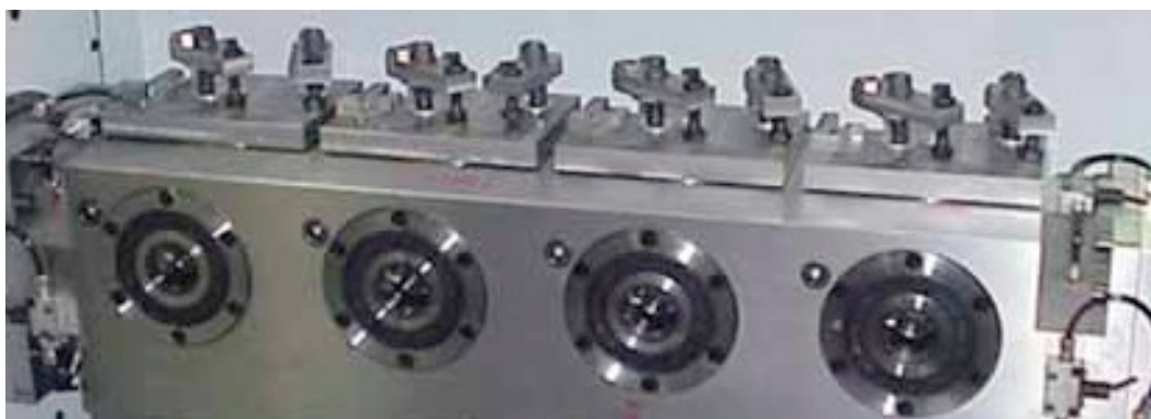
Kuva 53 Indeksioivia paletteja, joihin on rakennettu yksinkertaiset standardiosista rakennetut kiinnittimet. (Unilock, 2006, s. 23)
