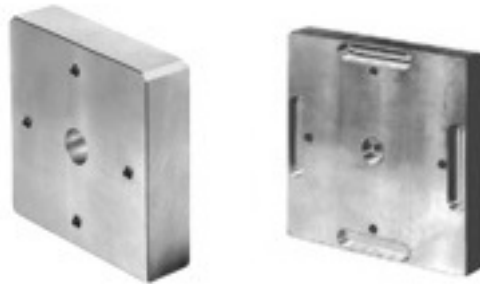
Kuva 42 Indeksoivoa paletteja. Kummassakin vetotapin kiinnitysreiän ympärillä kehällä neljä indeksointitapin kiinnitysreikää. (Vischer & Bolli, 2008)
