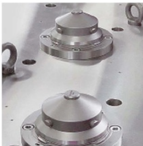
Kuva 49 Delphin BIG kiinnitinelementtejä pöydässä. Kiinnittimen ulkoreunalla sijaitsevat lukituskyynnet. (System 3R, 2007, s. 50)
