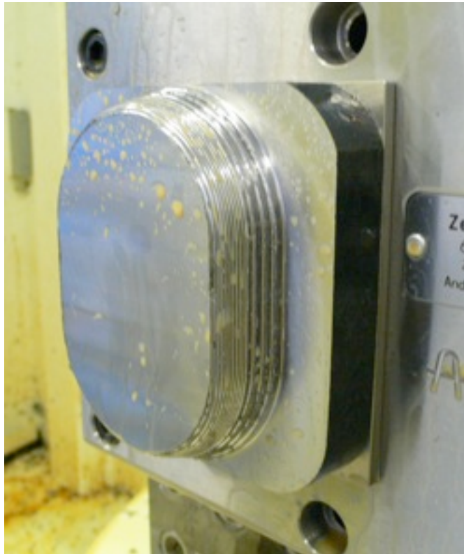
Kuva 66 Muottityökalun muotoja rouhinnan jälkeen. Lastuamissyvyys 1 - 3 mm
