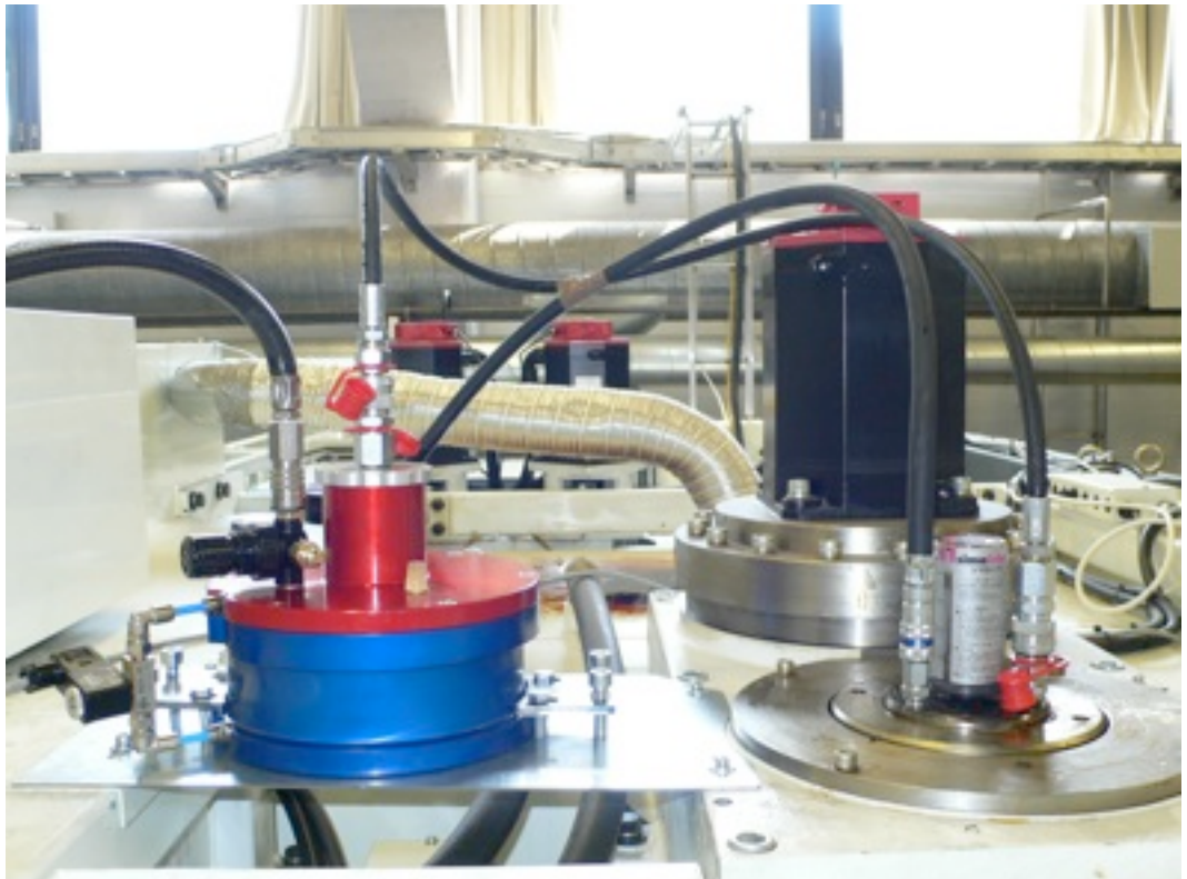
Kuva 59 Painevahvistin sijoitettuna koneistuskeskuksen päälle. Painevahvistinta käytetään sähköohjatusti. Hydraulii- ja paineilmalinjat kulkevat koneistuskeskuksen palettikarusellin akselin läpi kiinnittimelle.
