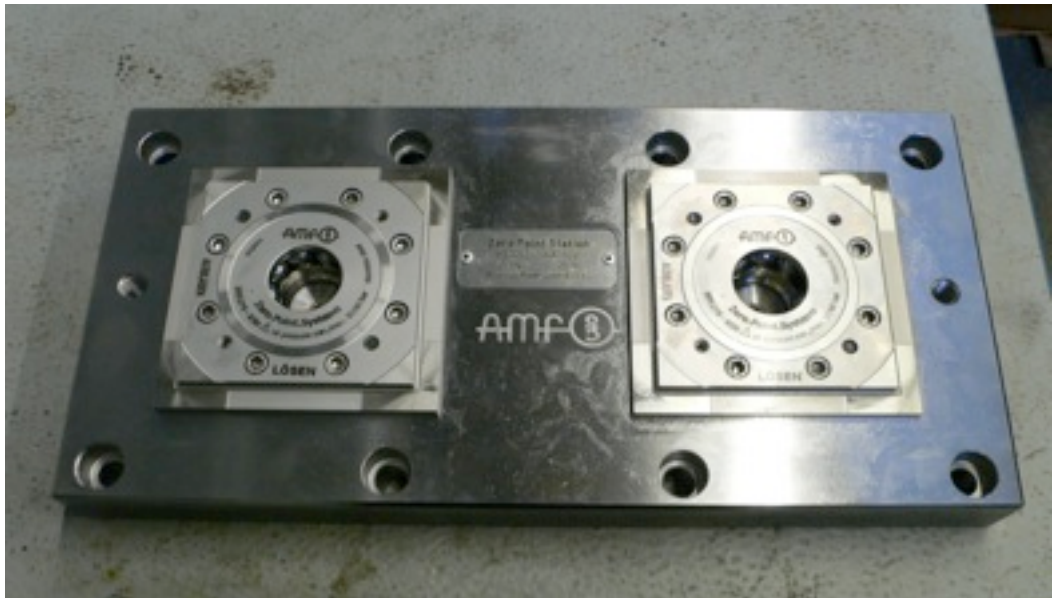
Kuva 58 Koneistuskeskuksessa käytetty peruslevy kahdella AMF:n indeksoivalla sylinterillä, käyttövoima hydraulikka
