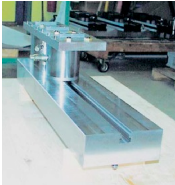
Kuva 40 Penkkikiinnitin säädettävällä sylinterijaolla. (Vischer & Bolli, 2008, s. 26)
