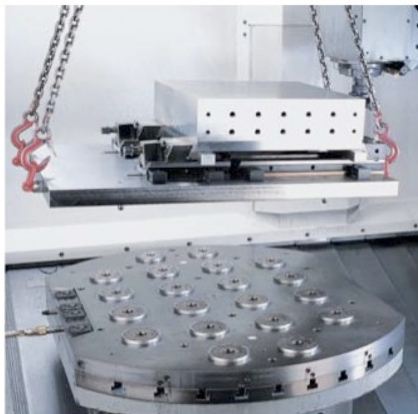
Kuva 55 Ruuvipuristimia nollapistepaletilla. (Vischer & Bolli, 2008, s. 3)
