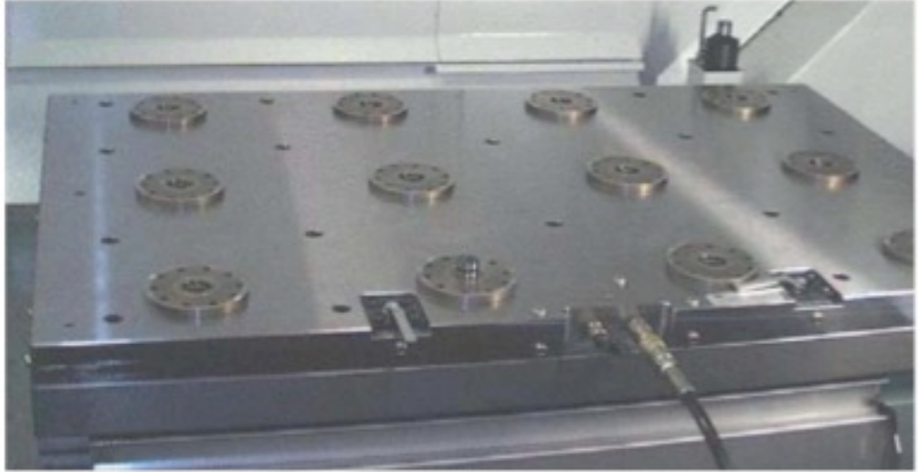
Kuva 26 Upotettavia sylintereitä peruslevyssä. Hydraulikka- ja paineilmaliihtimet levyn sivussa. (Vischer & Bolli, 2008, s. 8)
