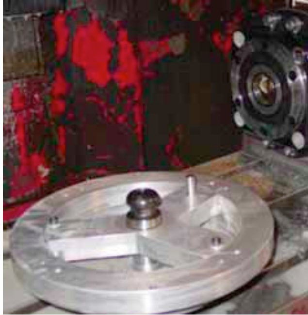
Kuva 48 Vetotappi ja indeksointitappi kiinnitettynä suoraan sorvattavaan kappaleeseen. Sorvin karassa on indeksoiva sylinteri. (Unilock, 2006, s. 20)
