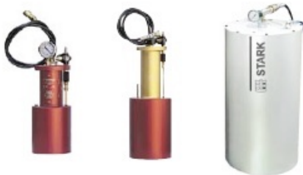
Kuva 16 Painevahvistimia. Vasemmalta lukien ensimmäisen mallin maksimipaine 40 bar / sylinterien suurin määrä 17 kpl, toisena 80 bar / 12 kpl, kolmantena 40 - 80 bar / 45 kpl (Stark Automation, s. 24)
