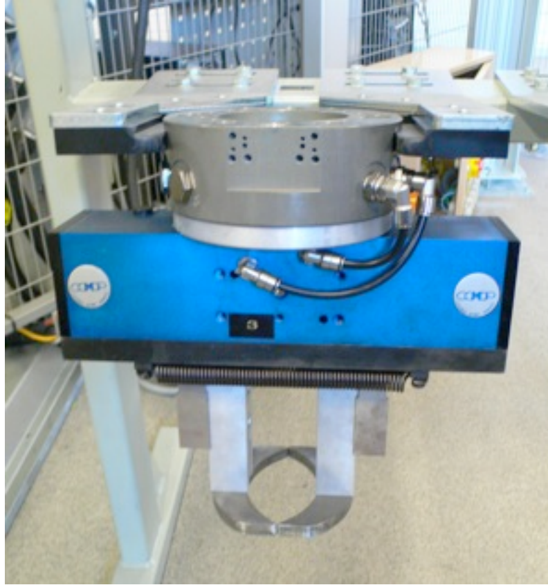
Kuva 67 Kappaleenkäsittelyrobotin lineaaritarrain, jossa leukojen lisäosat sylinterimäisien kappaleiden käsittelyyn
