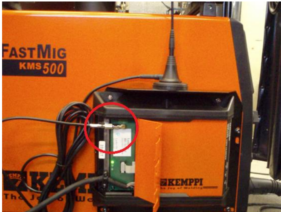
Kuva 9. Antennin kiinnitys lähettimen mikropiiriin. Antennin kiinnitys ympyröity punaisella.
