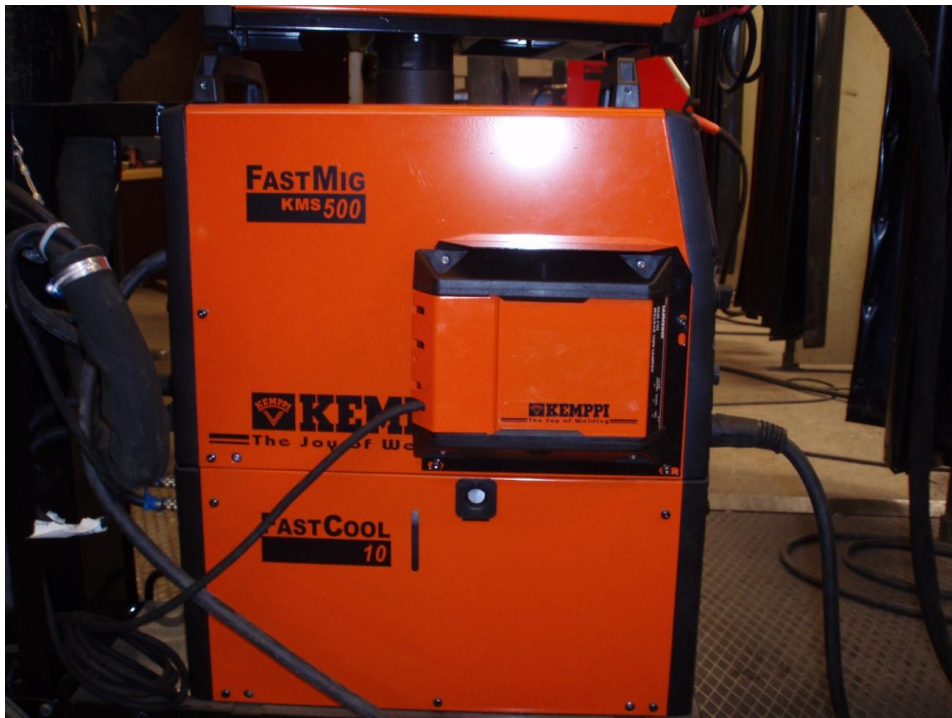
Kuva 8. Langattoman lähettimen DLI W50:n kiinnitys virtalähteeseen. Virtalähteenä kuvassa on FastMig KMS 500.
