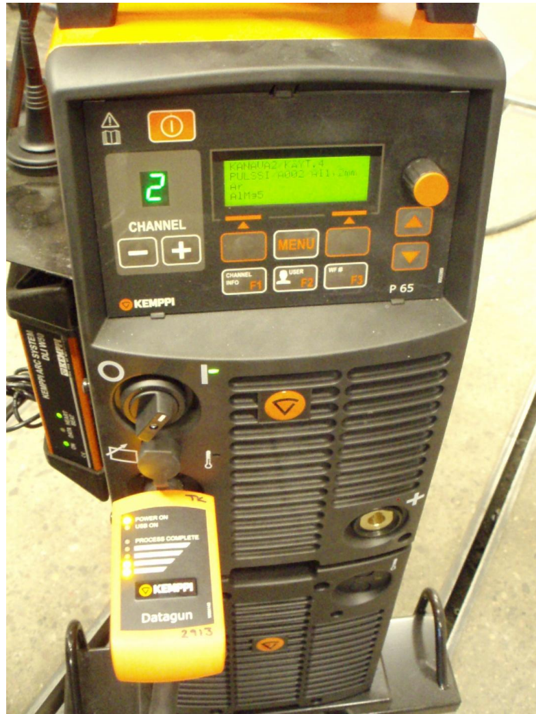
Kuva 10. Ohjelmiston päivitys DataGun- tiedonsiirtolaitteen avulla.
