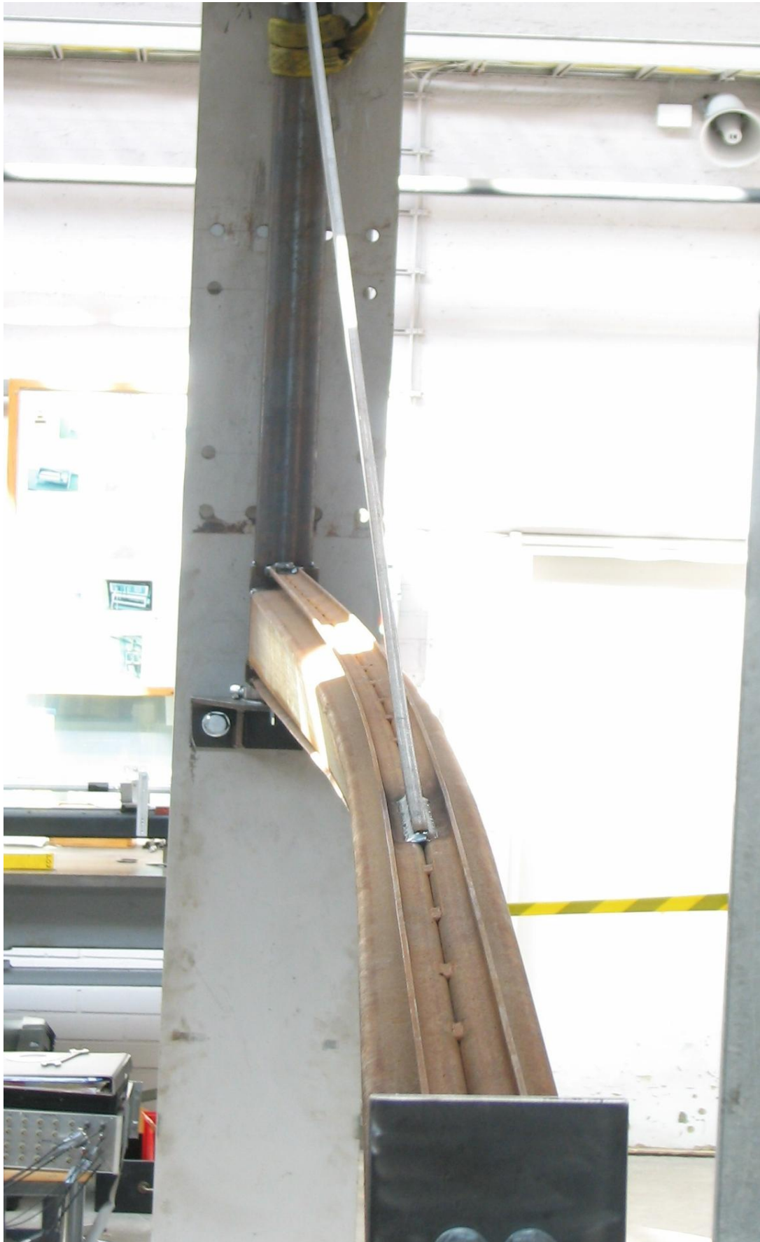
Kuva 11. Staattisessa kestävyyskokeessa kiepahtanut Uka40-palkki.
