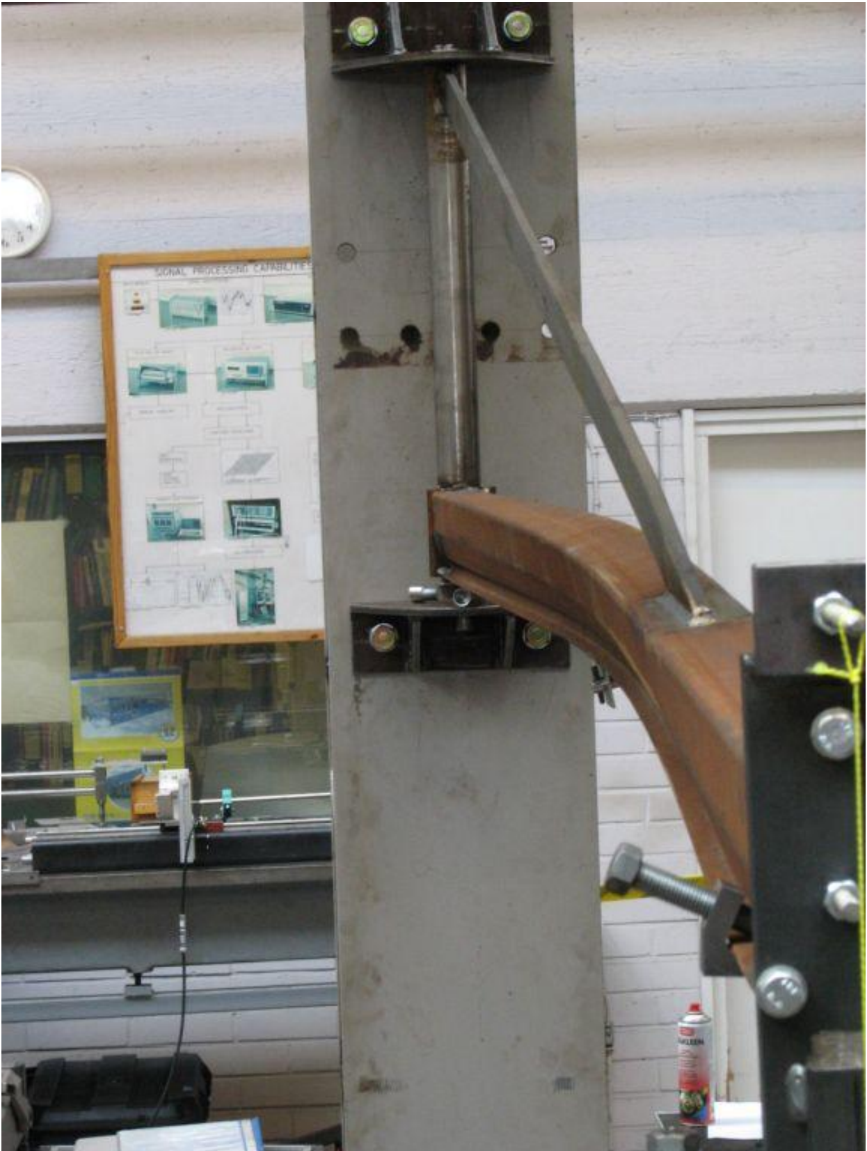
Kuva 9. Staattisessa kestävyyskokeessa kiepahtanut Uka20-palkki.
