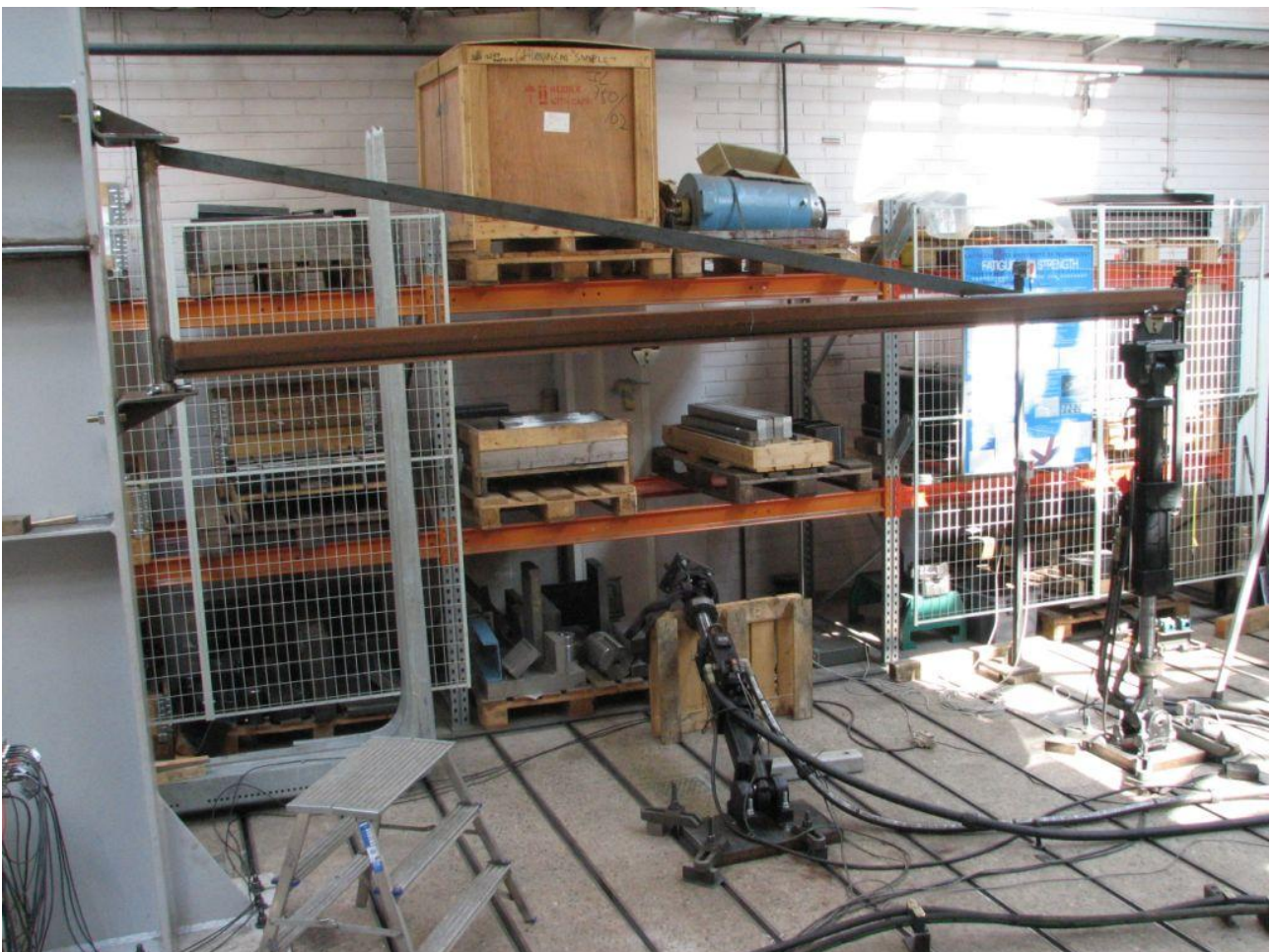
Kuva 8. Uka20-palkin staattisen kestävyyskokeen koejärjestelyt.
