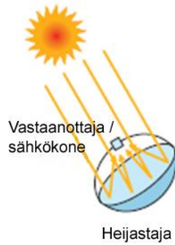
Kuva 10. Parabolisen peilipintaisen vadin toimintaperiaate. Polttopisteen yhteydessä on moottori tai generaattori. (Muokattu lähteestä IEA 2010, 12)
