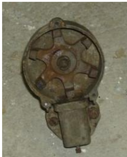
Kuva 3.2 Anturi ja sille herätteen antava sakarapyörä juuri dieselmoottorista purettuna.
