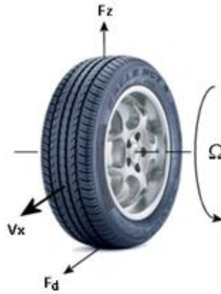
Kuva 7. Renkaan yksinkertaistettu pituussuuntainen dynamiikka [5]
