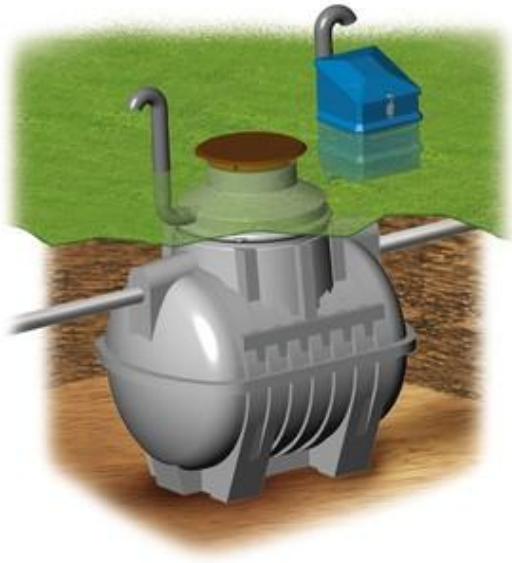
Kuva 8. Maahan upotettu pienpuhdistamo. (Pirkkalan kunta)
