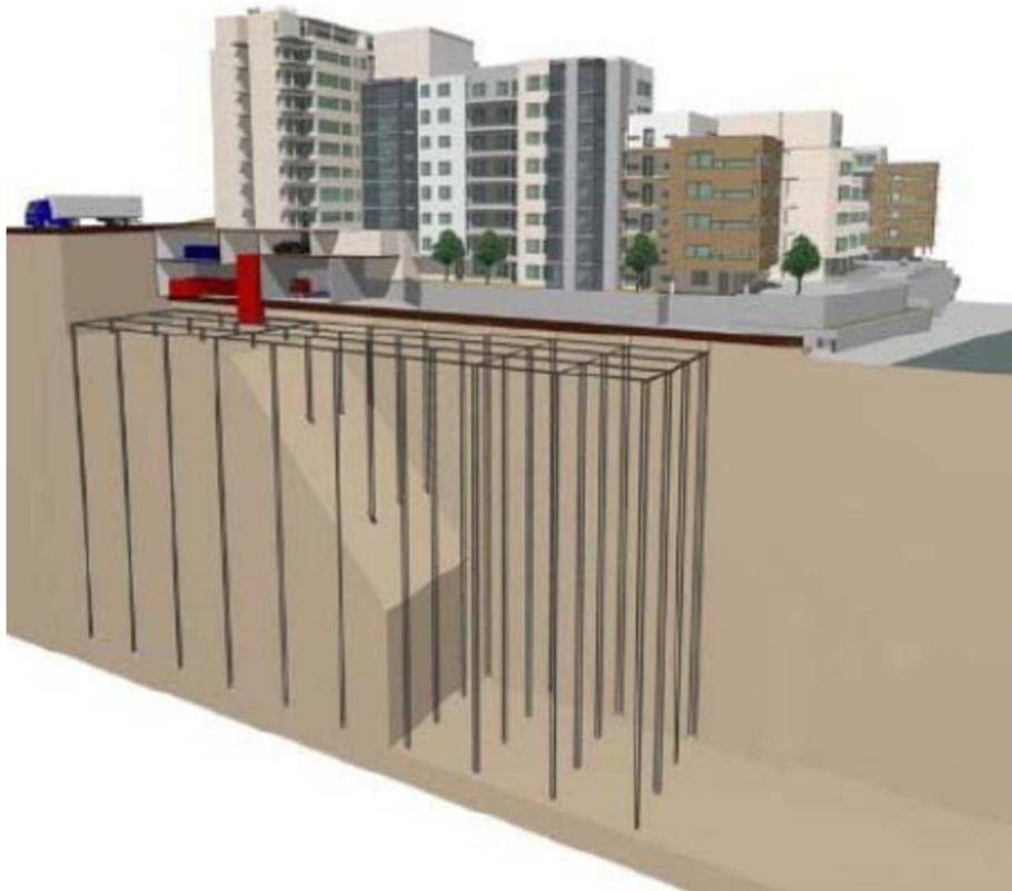
Kuva 23. Periaatekuva maan alle sijoitettavasta maalämpöverkostosta (GTK 2008).
