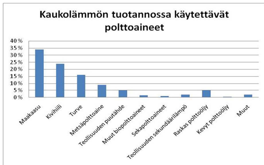
Kuva 4. Kaukolämmön ja siihen liittyvän sähkön tuotannossa käytettävien polttoaineiden osuudet (Energiateollisuus ry 2010).
