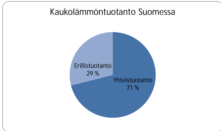
Kuva 3. Kaukolämmöstä suurin osa tuotetaan sähkön ja lämmön yhteistuotantona voimalaitoksissa (Koskelainen 2006, 37).
