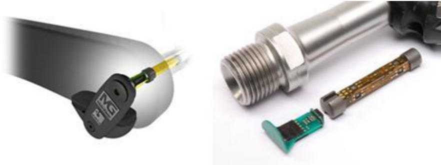
Kuva 7. MetriGear Vector ja poljinakselin sisällä oleva venymäliuskakomponentti (MetriGear 2010a).
