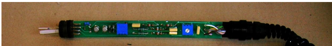
Kuva 4.2: Vaisalan Humicap 1638 HM kosteusanturi, josta on irrotettu anturisuojus ja vaippa- putki.
