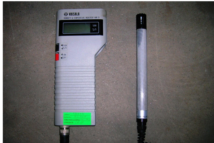
Kuva 3.2: Vaisalan digitaalinen kosteus- ja lämpömittari. Oikealla kapasitiivisen ja PT-100 -anturin sisältävä mittapäää HMP 31 UT.
