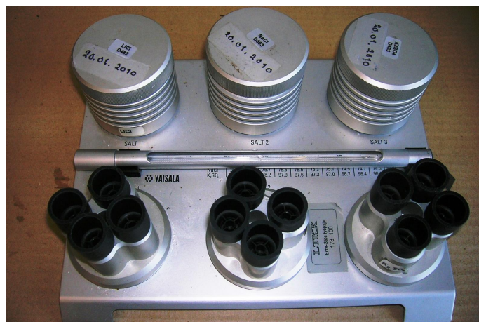
Kuva 4.1: Vaisalan HMK 15 kosteuskalibraattori kapasitiivisen anturin kalibrointiin.
