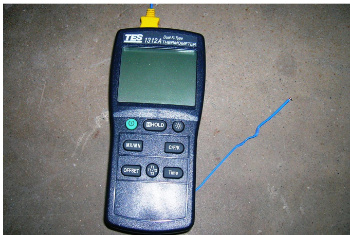
Kuva 3.15: TES 1312A -mittalaite ja k-tyypin termoelementti.
