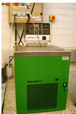
Kuva 4.4: Frigomix -kalibraattorin vesihaude termoelementin kalibrointiin.
