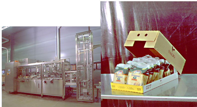
Kuva 11. Valio Oy Vantaan tehdas, ryhmäpakkauskone ja ryhmäpakkaus (Valio Oy Vantaan tehdas).
