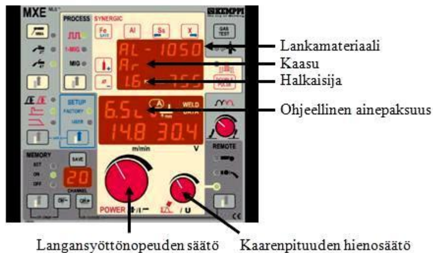
Kuva 38. Yksinuppisäädön synergiset toiminnot ja hitsausparametrien säätö langansyöttönopeuden mukaan (Synergiset toiminnot s. 1).
