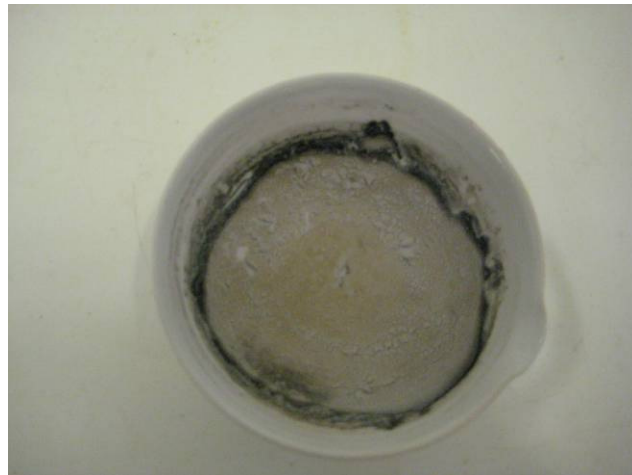
Kuva 5. Lingoille menevä bioliete 600 °C:n hehkutuksen jälkeen.
