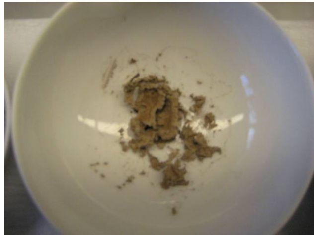
Kuva 8. Ensimmäisen lingon jälkeisen biolietteen hehkutusjäännös 800 °C:n jälkeen.
