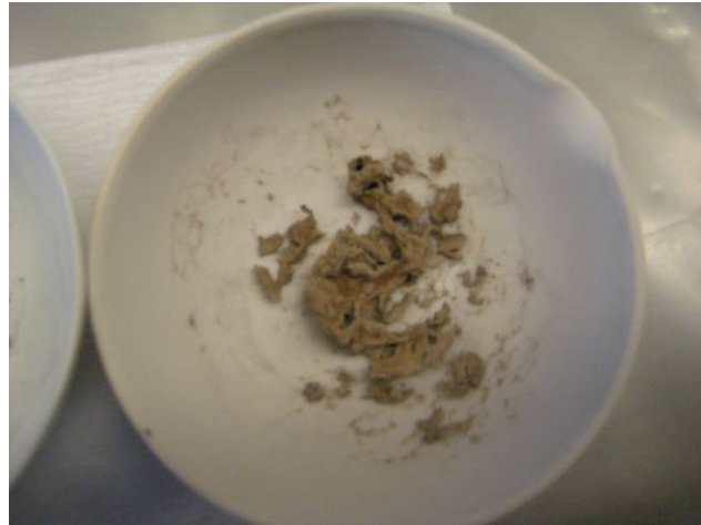
Kuva 9. Toisen lingon jälkeisen biolietteen hehkutusjäännös 800 °C:n jälkeen.
