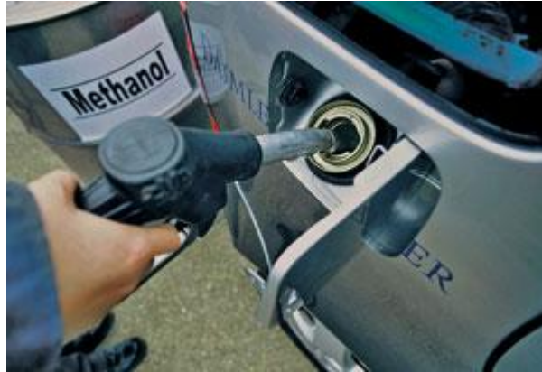
Kuva 6. Metanoli syövyttää autojen nykyisiä polttoainejärjestelmiä (Kemsley 17 ).
