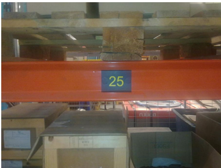
Kuva 6. Kuvassa on esimerkki vaakapalkkiin kiinnitettävästä hyllyosoitteesta.
