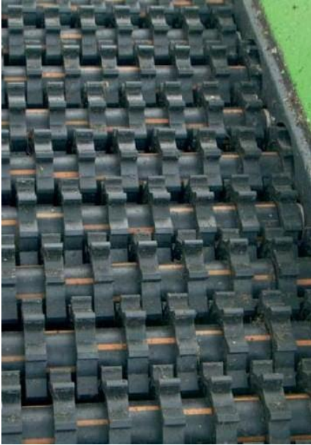
Kuva 8. Tähtiseulan rakenne (Neuenhauser, 4).
