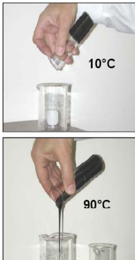
Kuva 6. Bitumi on hyvin mustaa ja jähmeää. Lämpötilan nousu laskee bitumin viskositeettia (Belyk [10]).
