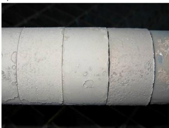
Kuva 43: Renkaat 1 – 3 korroosioselvitys normaaliajossa (a) ja ammoniumsulfaatti lisäyksessä (b) (Broström M. et al. 2007, 1174.)
