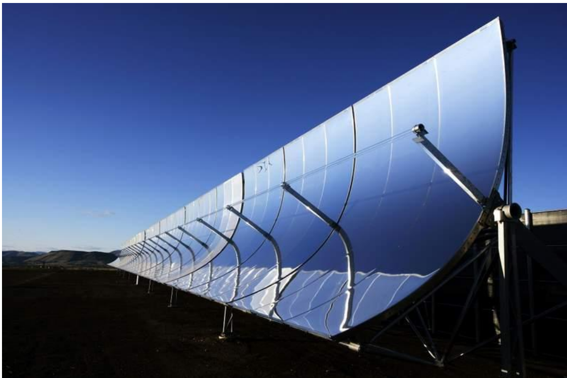
Kuva 2.7 Keskittävä keräin yhden akselin kääntömoottorilla varustettuna. Auringonsäteet kohdistetaan fokusointisuoralle, jossa on tyhjiöputkessa virtaavaa lämmönsiirtonestettä (Solar Thermal Magazine 2011).
