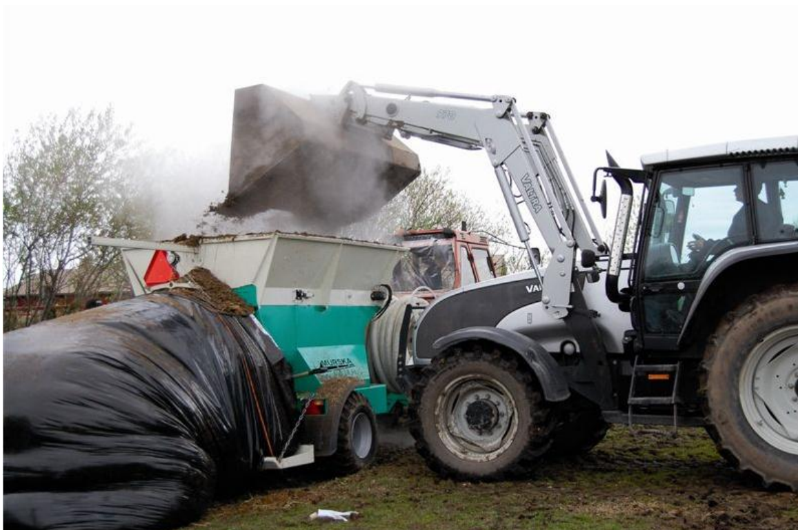
Kuva 5. Murska Biopackerin tuubikompostin täyttö (Aimo Kortteen Konepaja Oy)
