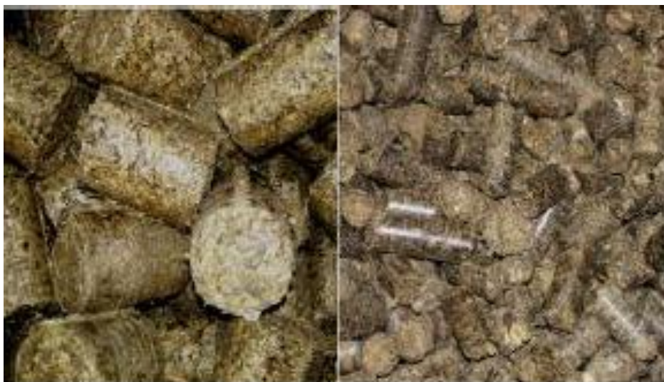
Kuva 2. Hevoselantabrikettejä (vasemmalla) ja -pellettejä (oikealla) (Demmel Bioenergie 2011).
