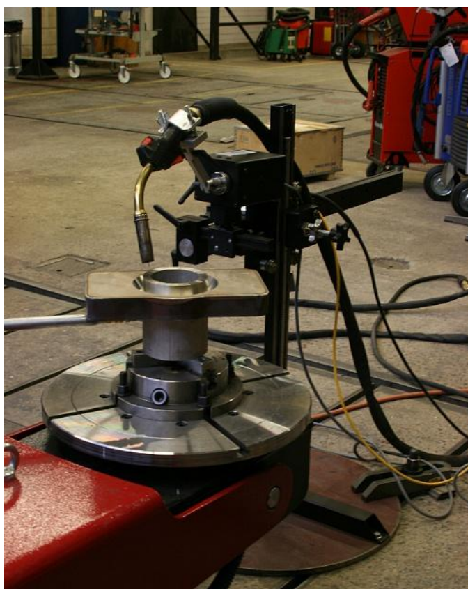
Kuva 6. Koehitsauksessa kappaleiden pyörittämiseen käytetty pyörittäspöytä ja hitsauspistoolinpidin.
