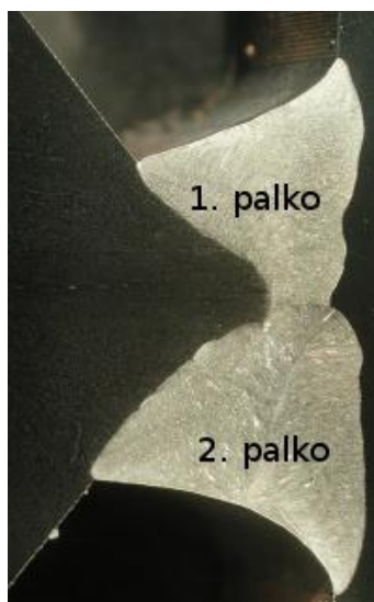
Kuva 9. Makroskooppikuva lisäaineella 308LSi MAG-hitsatuista pohjapaloista. Palon 2 syvyys on noin 10 mm ja leveys 14 mm.
