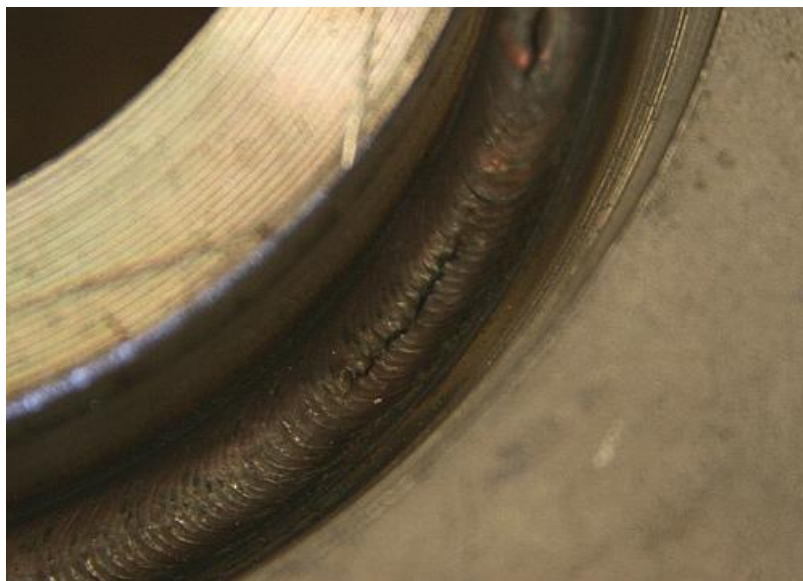
Kuva 7. Hitsin loppupäähän syntyneitä kuumahalkeamia.
