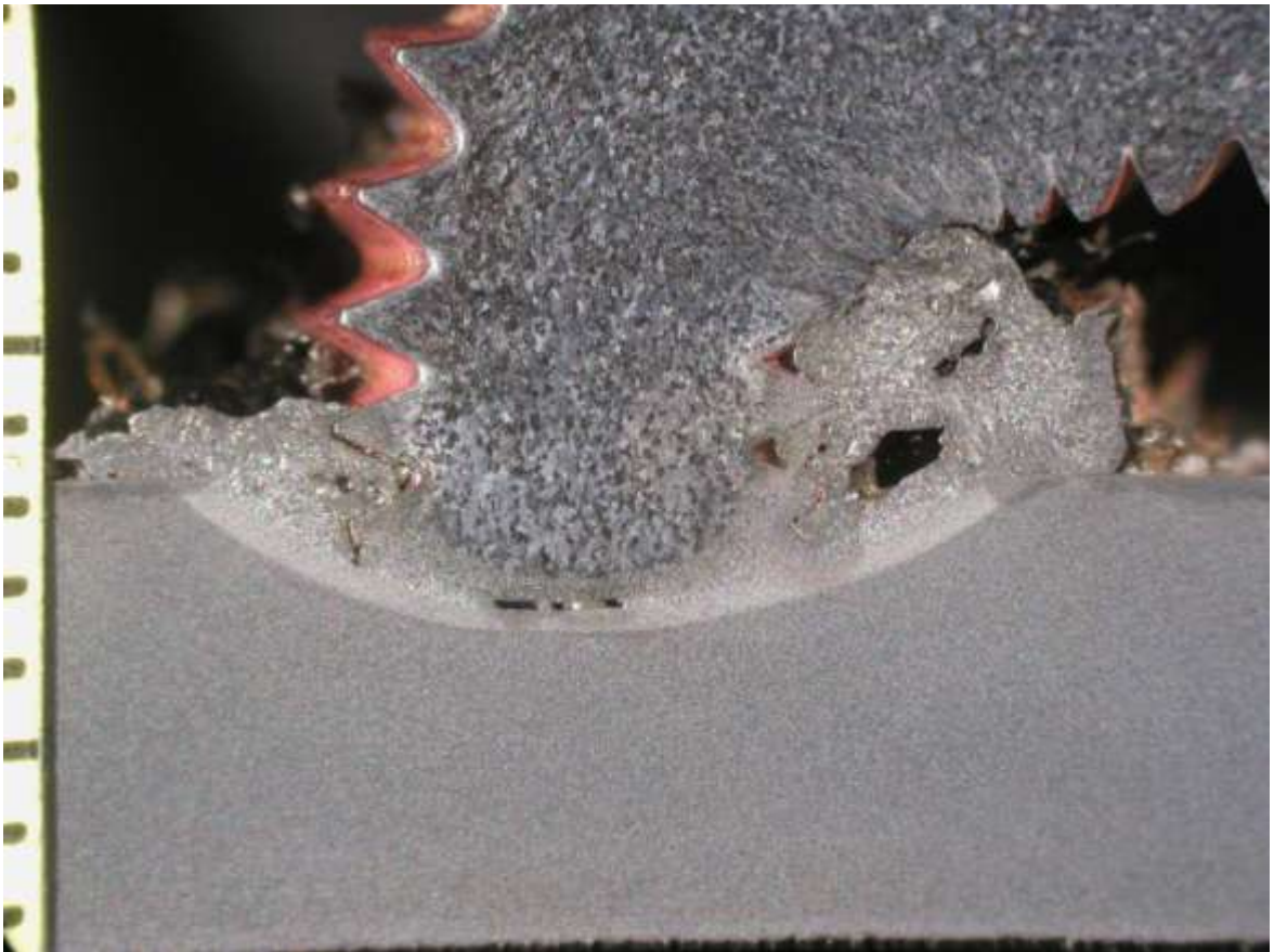
Kuva 17. Makrokuva taivutuskokeen läpäisseestä hitsausliitoksesta.
