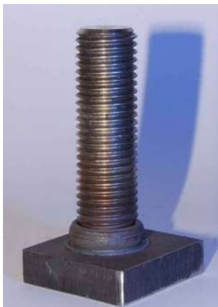
Kuva 6. Valmis hitsi (What Is Friction Stud Welding)
