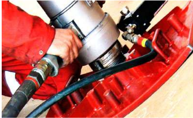
Kuva 7. Hitsauspää ja vakuumikiinnitteinen hitsauspään kiinnitin eli clamp (Infrastructure Services - Friction Stud Welding).
