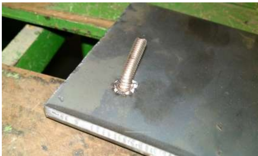
Kuva 16. Kuivassa hitsattu taivutuskokeen kestänyt tappi
