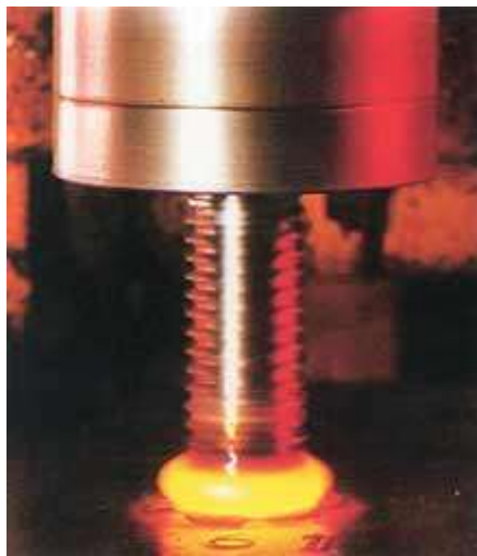
Kuva 5. Kitkatapitushitsauksessa kuumeneva hitsaustappi (IEV Group)
