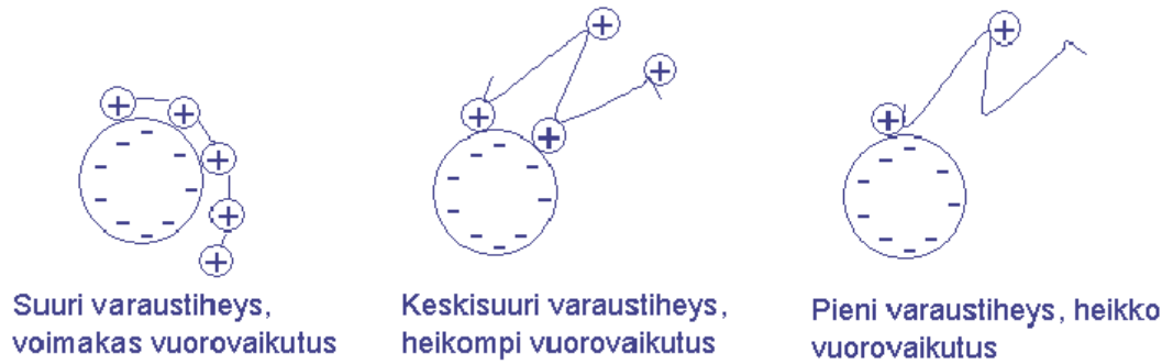
Kuva 11. Varaustiheyden vaikutus partikkeleiden ja kationisen polymeerin vuorovaikutuksiin /11/
