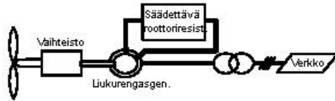
Kuva 8. Muuttuvanopeuksinen tuulivoimala muutettavalla roottorin resistanssilla (Laaksonen et al., 2003, s.18).
