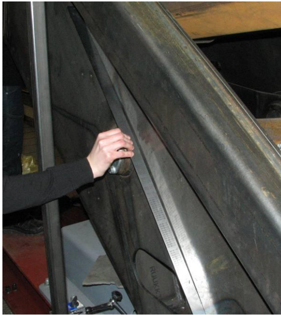
Kuva 12. Kuormitustapaus 1. Puomin jalustan muodonmuutos.
