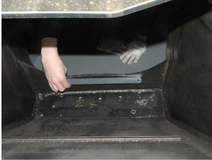
Kuva 13. Kuormitustapaus 1. Jalustan jäykisteen lommoutuminen.
