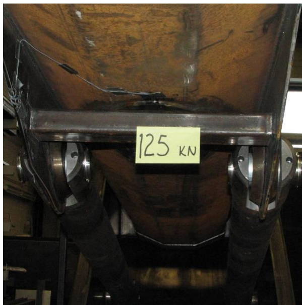
Kuva 11. Kuormitustapaus 1. Sylinterien korvakkeiden lommahdus.
