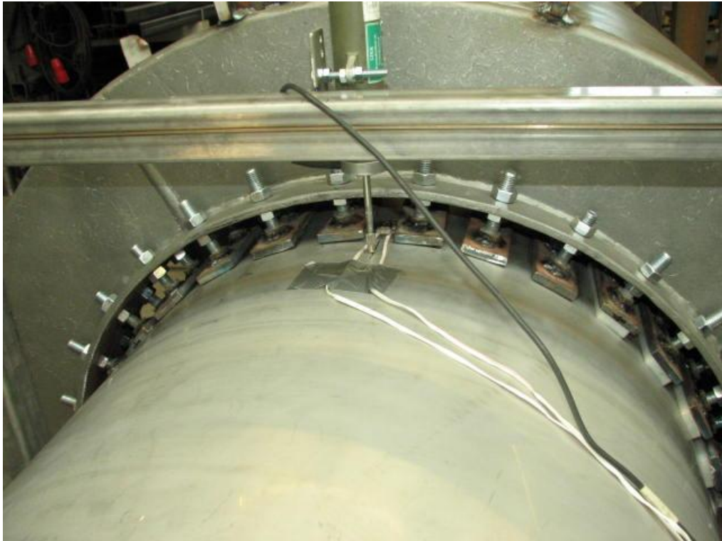
Kuva 20. Yläreunan tukipalat ilman muovikappaleita testissä 2
