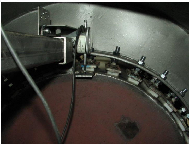
Kuva 11. Putken alapään siirtymää mittaava anturi ja sen teline
