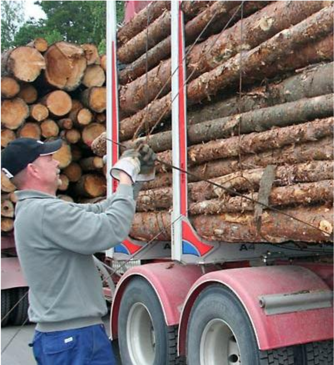
Kuva 1. Tukkinipun sidontaa käsin (Kariniemi et al. 2010).
