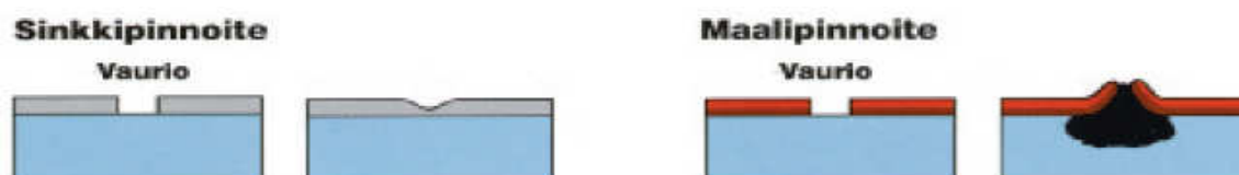
Kuva 36. Sinkkipinnoite korjaa vaurion itsestään. (Suomen kuumasinkitsijät ry 2012)
