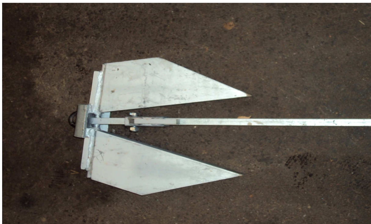
Kuva 16. Danforth-ankkurissa siivet pyörähtävät varressa ympäri. (Lappeenrannan kanavansuu 2012)
