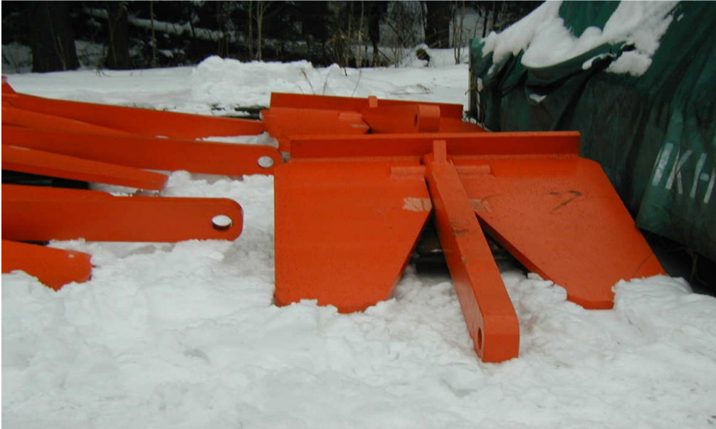
Kuva 17. Raskaissa meripuomeissa käytettävä ankkuri, johon on hitsattu levy päähän kiinnestämään ankkurin laahautumista pohjassa. (Suomen ympäristökeskus 2012)
