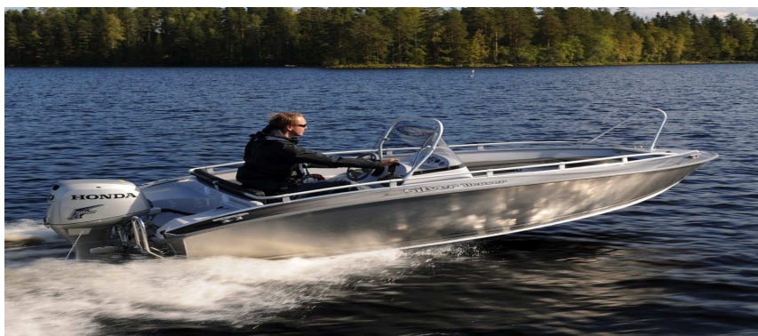
Kuva 22. Al-Mg-seoksesta valmistettu vene. (Silverboats 2012)
