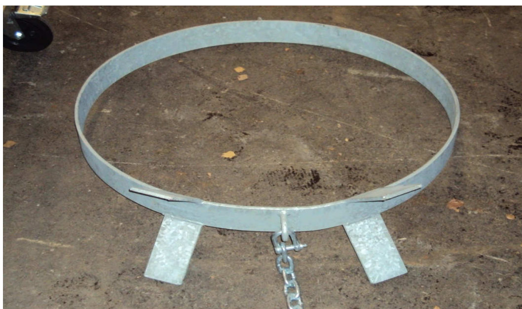
Kuva 15. Rengasankkuri, jossa hitsatut metallipalat pyrkivät estämään ankkurin liukumista pohjassa. (Lappeenrannan kanavansuu 2012)
