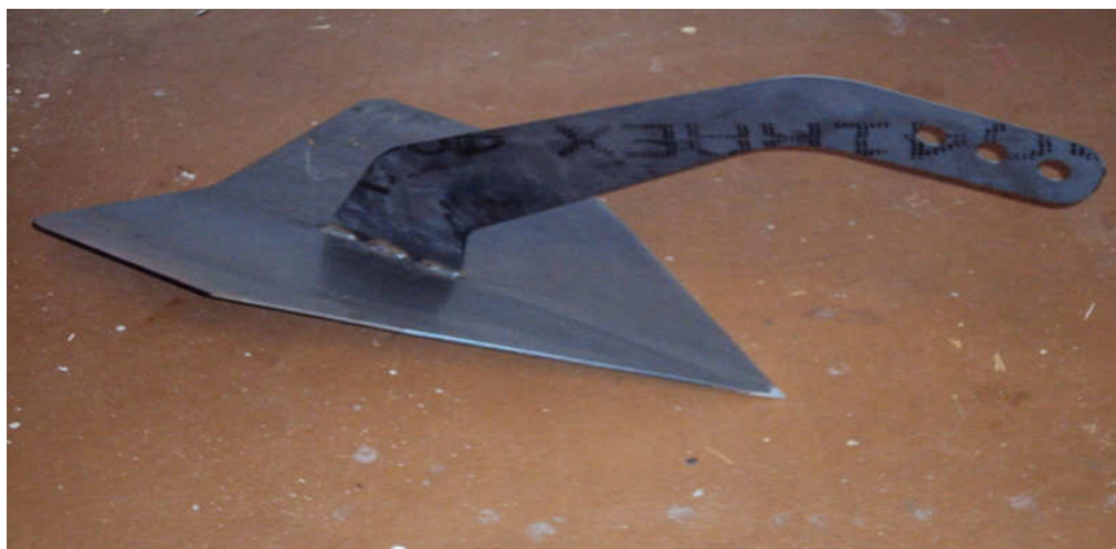
Kuva 49. Testausta varten valmistettu pienemmän ankkurin prototyyppi.
