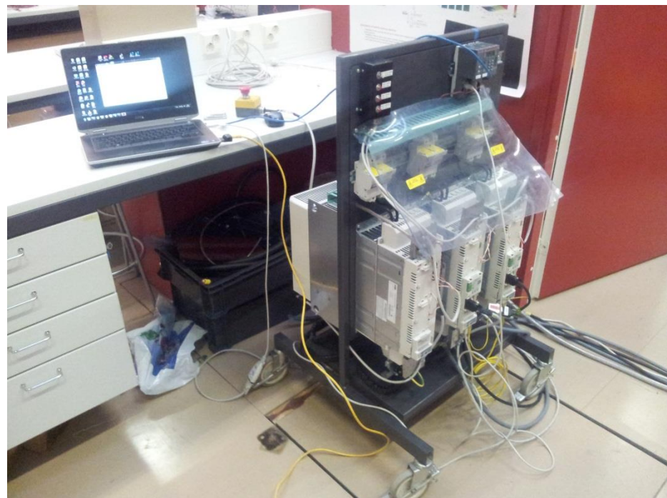
Kuva 4.3. Hardware-in-the-Loop-simulaation ACSM1-taajuusmuuttajat sekä verkkovaihtosuuntaaja, AC500-logiikka ja CCRTicle -rajapintasovellusta suorittava kannettava tietokone.
