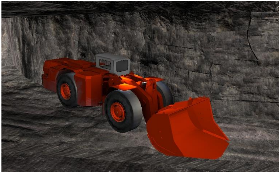
Kuva 1.2. Maanalaisen kaivoslastauskoneen ja työympäristön virtuaalimalli.
